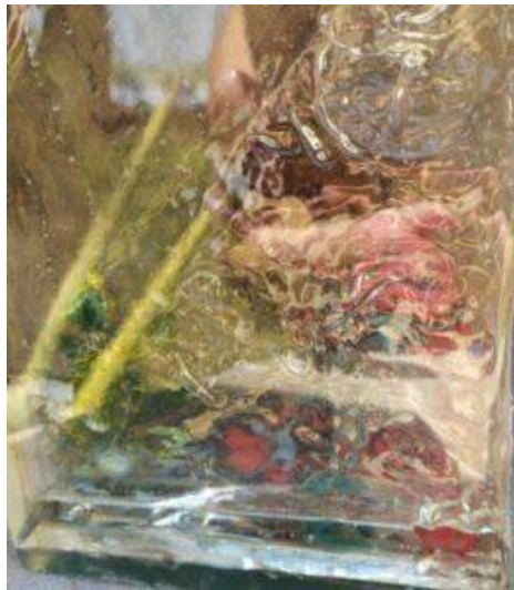
Figura 12: Resina epóxi com presença de superfície pegajosa.
