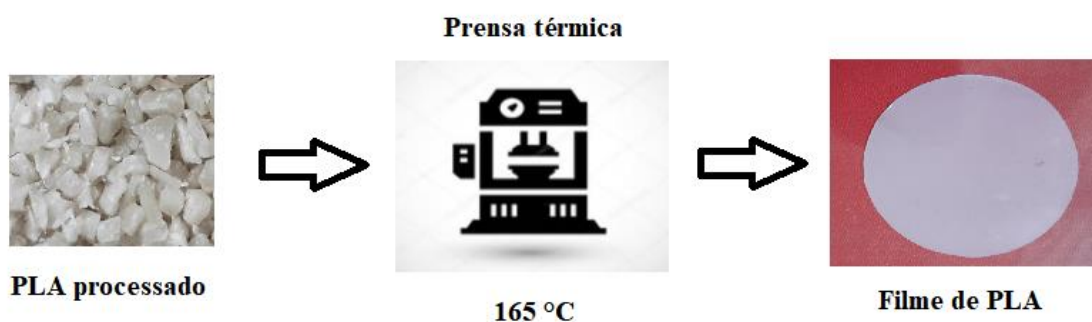
FIGURA 4.3 – Processo para obtenção de filmes de PLA e PLA contendo diferentes proporções mássicas de \alpha\text{-Ag}_2\text{WO}_4 por termoprensagem.
