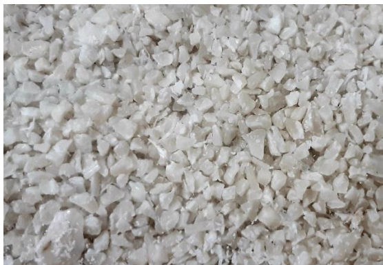
FIGURA 4.2 – Amostra de PLA puro processado por reometria de torque por 4 min à 210 °C e 50 rpm.
