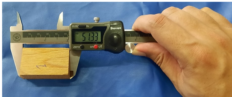
Figura 19: Corpos de prova para a determinação da \rho_{ap,12\%} .
