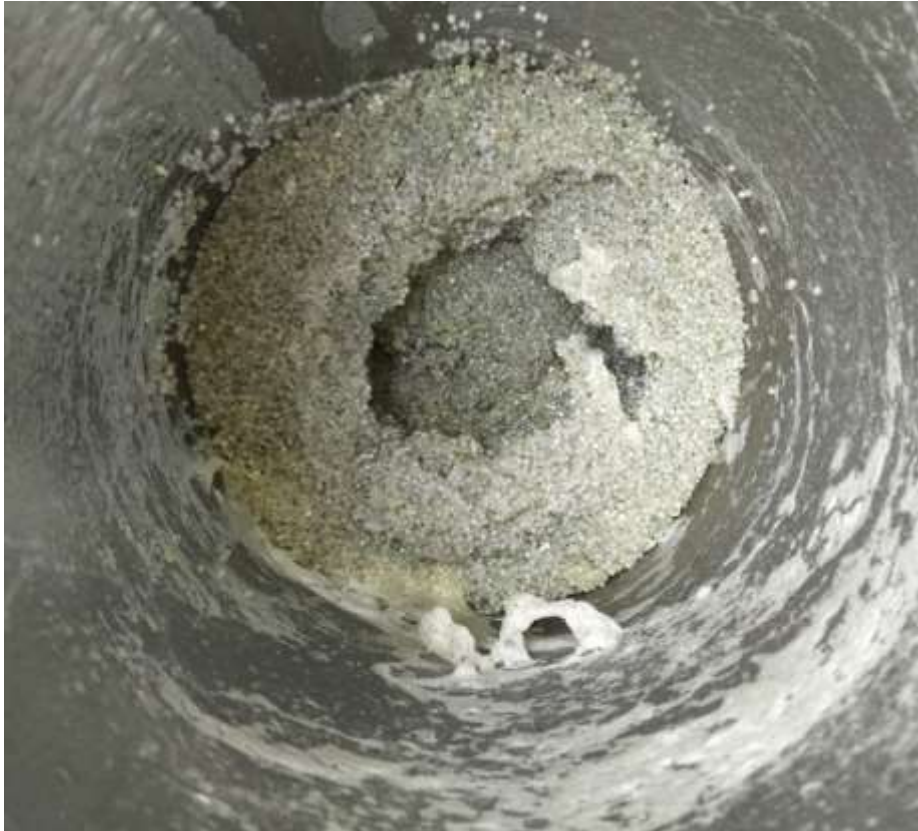
Figura 4.33 – Interior do leito de jorro na secagem de leite desnatado com agitador tipo parafuso helicoidal. Dados: Velocidade de rotação de 120 rpm e vazão de ar de 1,04 \text{ m}^3 \cdot \text{min}^{-1} .
