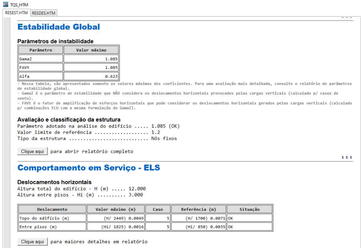
Figura 55: \gamma_z e deslocamentos horizontais para TO-04.
