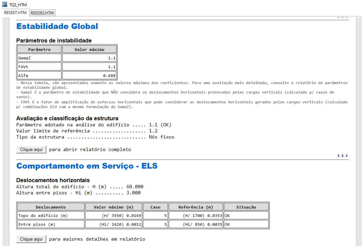
Figura 67: \gamma_z e deslocamentos horizontais para TO-20.
