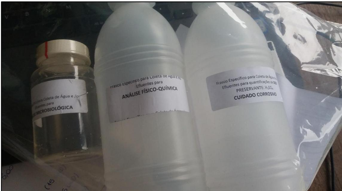
Figura 8 - Frascos utilizados para armazenamento das amostras de qualidade da água.
