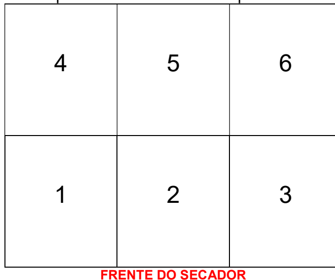
Figura 4.16. Vista superior das regiões da bandeja do primeiro estágio analisadas quanto à umidade final do produto.
