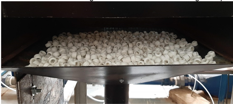
Figura 5.14. Visão superior do leito fixo com uma placa metálica de 4 pol de aresta, uma camada de bolas de gude e uma de anéis de Raschig de ½ pol.
