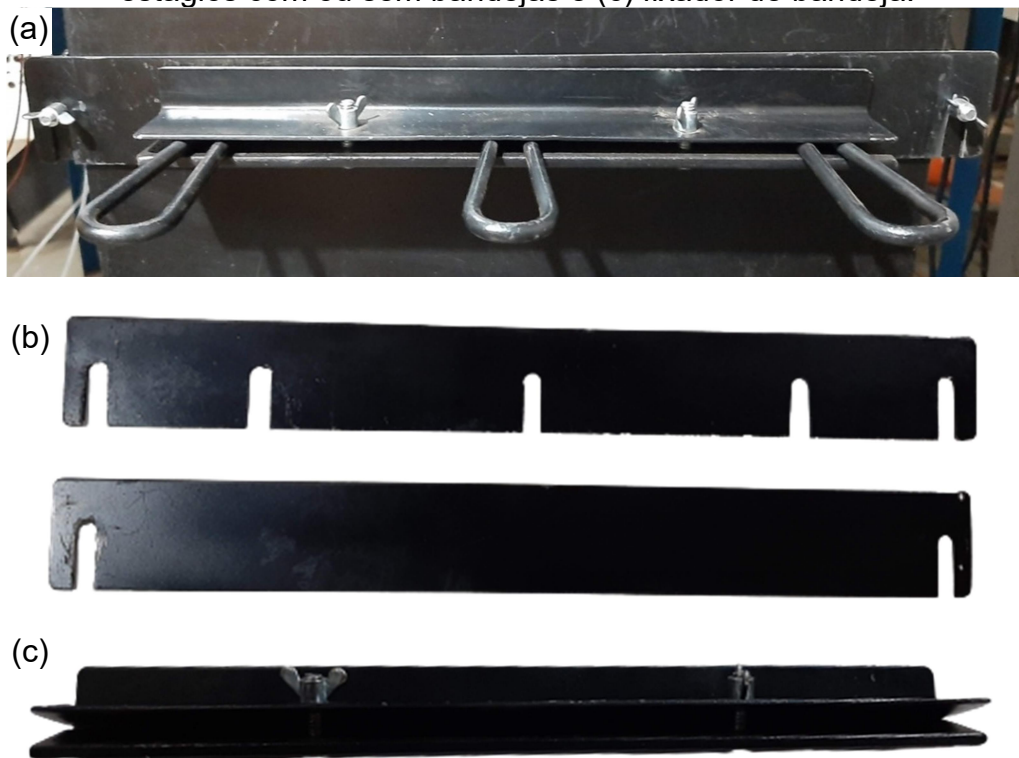
Figura 5.12. (a) Seções da bandeja fixadas e abertura vedada: (b) vedações para estágios com ou sem bandejas e (c) fixador de bandeja.
