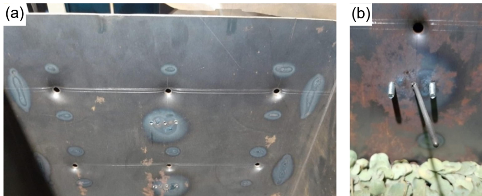
Figura 5.10. Parede posterior do secador: (a) furos de inserção do cabo de sustentação das seções da bandeja e (b) parafusos que evitam o contato da seção central com o termopar durante o despejo.
