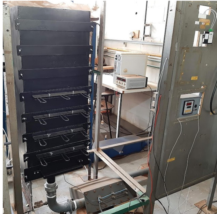
Figura 5.8. Linha do secador de bandejas com 4 estágios operando simultaneamente.
