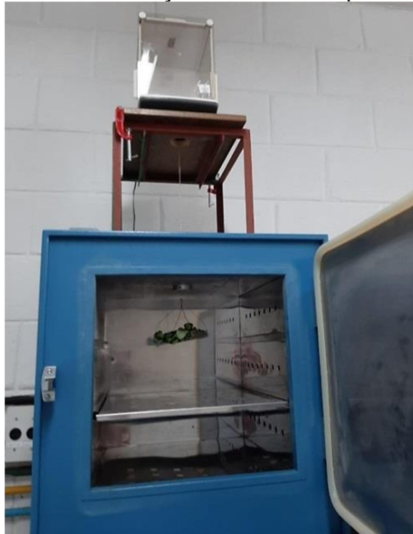
Figura 4.2. Estufa com medição de massa suspensa pela balança.
