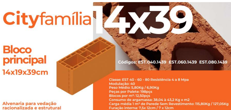
Figura 4 – Principal bloco da família 39 com paredes vazadas
