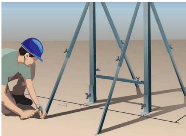
Figura 26 - Fixação de gabaritos nos vãos das portas
