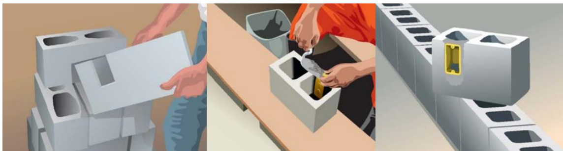
Figura 34 - Preparação de blocos com caixas elétricas
