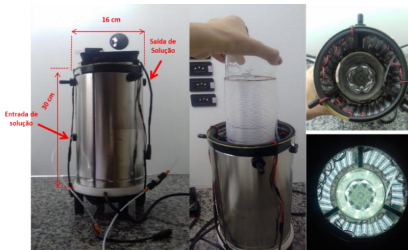
Figura 12 - Reator fotoquímico em tubo de PFA (1/8 in, O.D), construído no LQBO 60 .
