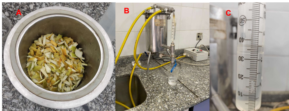
Figura 1. A) Cascas de limão. B) Destilador a vapor. C) óleo extraído e recolhido na seringa.
