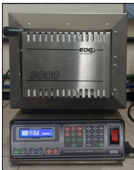
Figura 5.21 – Forno elétrico tipo mufla utilizado para a calcinação do caulim e do metacaulim comercial para obtenção de precursores geopoliméricos [autoria própria].
