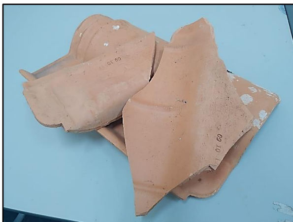
Figura 4.2 – Resíduo de construção civil proveniente de cerâmica vermelha [autoria própria].
