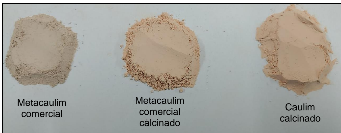
Figura 5.22 – Imagens das amostras de metacaulins antes e após tratamento térmico em 750°C durante 3 horas [autoria própria]
