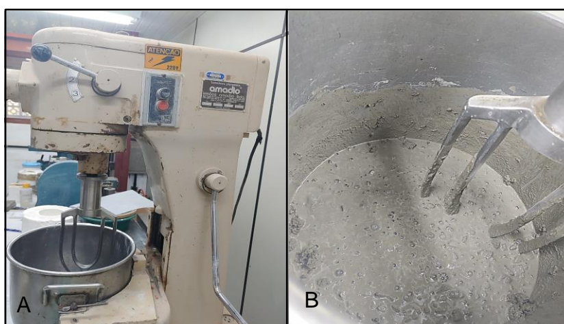
Figura 4.5 –Mistura do concreto de referência: (a) misturador planetário; (b) concreto de cimento Portland e brita [autoria própria].
