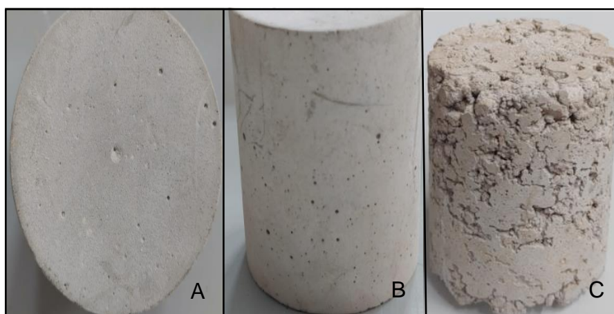
Figura 5.16 – Imagens dos corpos de prova das composições selecionadas após ensaio de envelhecimento acelerado: (a) CPB; (b) CPRU e (c) CPR [autoria própria].
