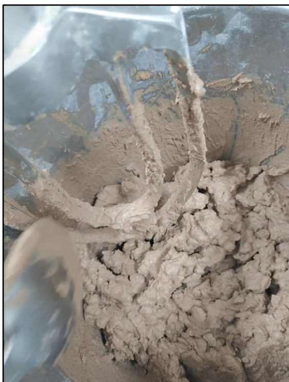
Figura 4.11 – Mistura do concreto geopolimérico [autoria própria].
