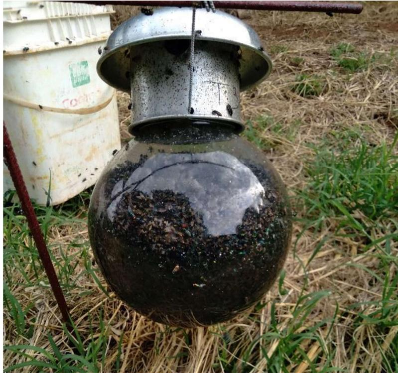
**Figura 2.** Armadilha globular de vidro e tampa de alumínio com três orifícios igualmente distanciados, para captura de moscas, com isca à base de fígado suíno.
