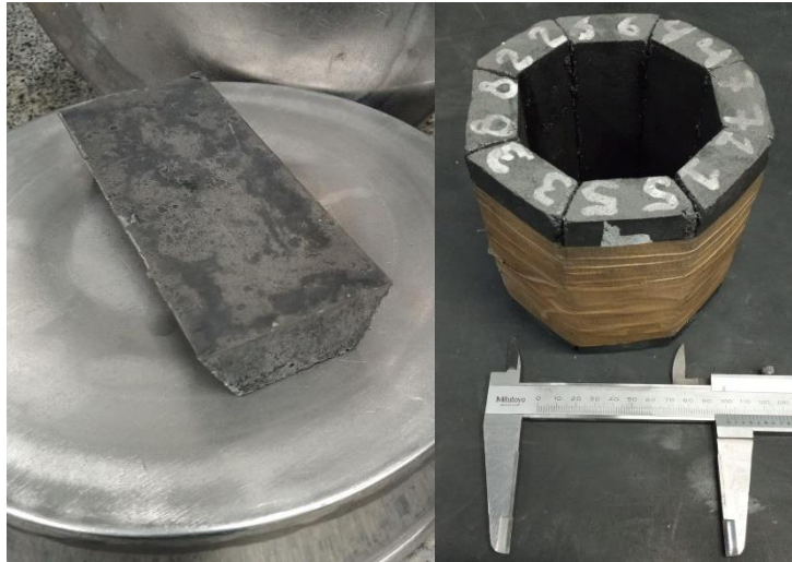
Figura 20: Corpo de prova para o ensaio de corrosão ao lado esquerdo e o conjunto completo montado para o ensaio ao lado direito.
