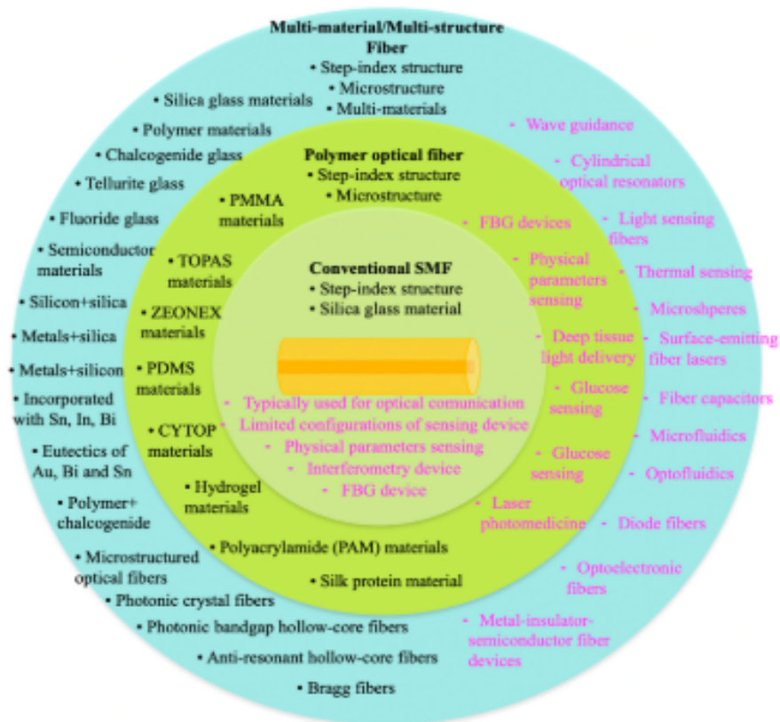
Figura 18: Materiais típicos e funções para as fibras ópticas.
