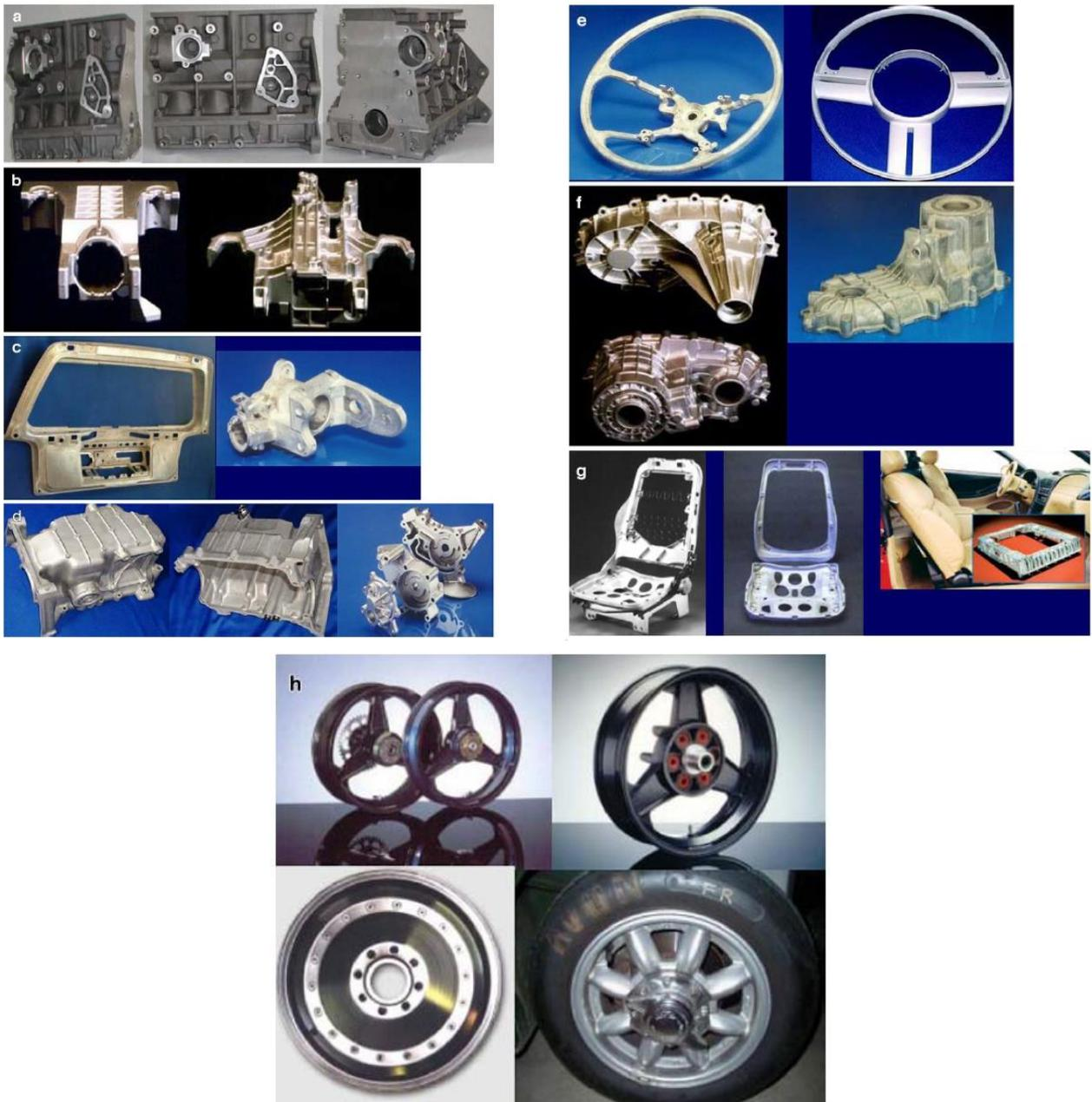
Figura 6- Componentes de automóveis fabricados com ligas de magnésio (a: bloco motor, b: módulo de coluna de direção, c: estrutura de porta, d: Cáster inferior, e: volante, f: carter da caixa de velocidades, g: estrutura do banco, h: jantes ou aros) (KULEKCI, 2008)
