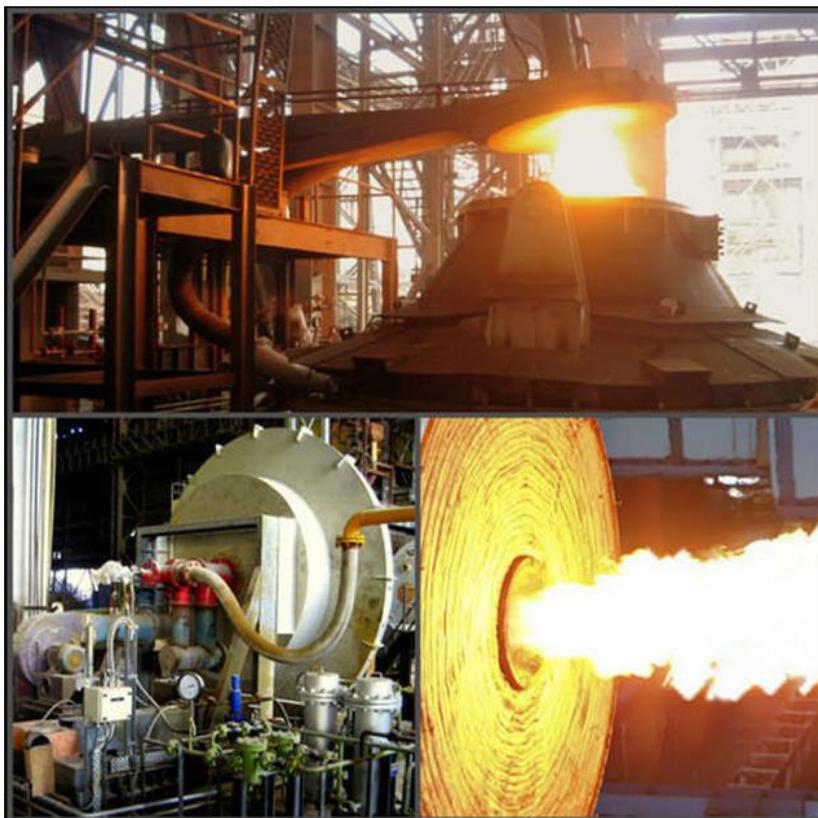
Figura 2.13 - Queimadores para pré-aquecimento de placas de aciaria.
