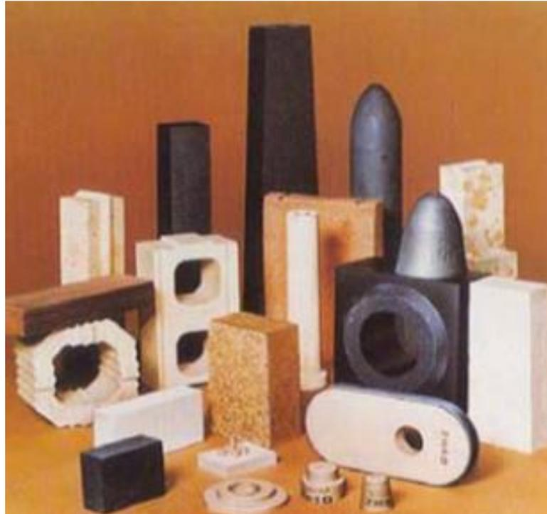
Figura 2.17 - Materiais refratários conformados [34].
