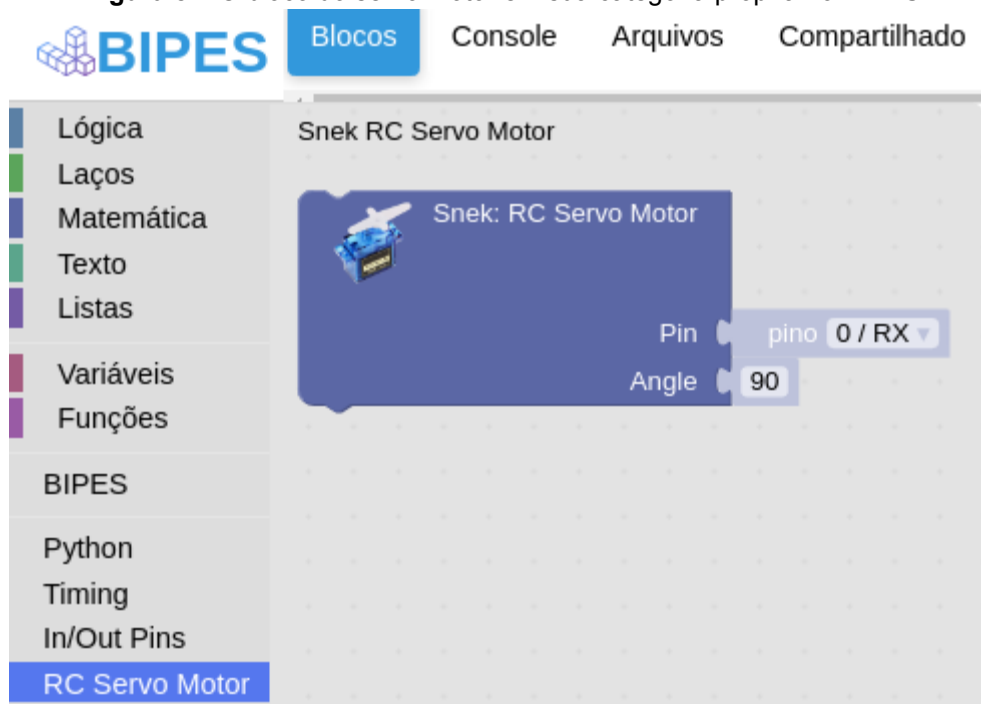
Figura 8 – O bloco do servo motor em sua categoria própria no BIPES
