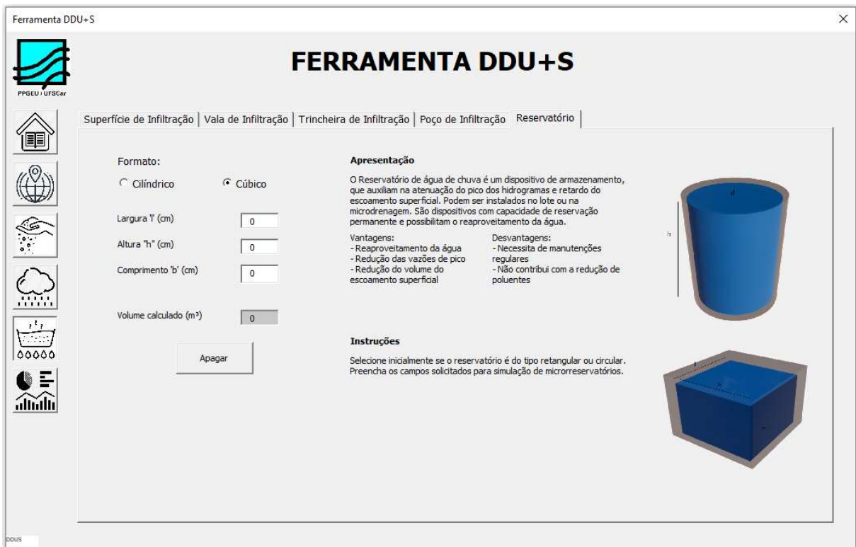
Figura 56 – Tela de Configuração do reservatório de água de chuva na Ferramenta DDU+S
