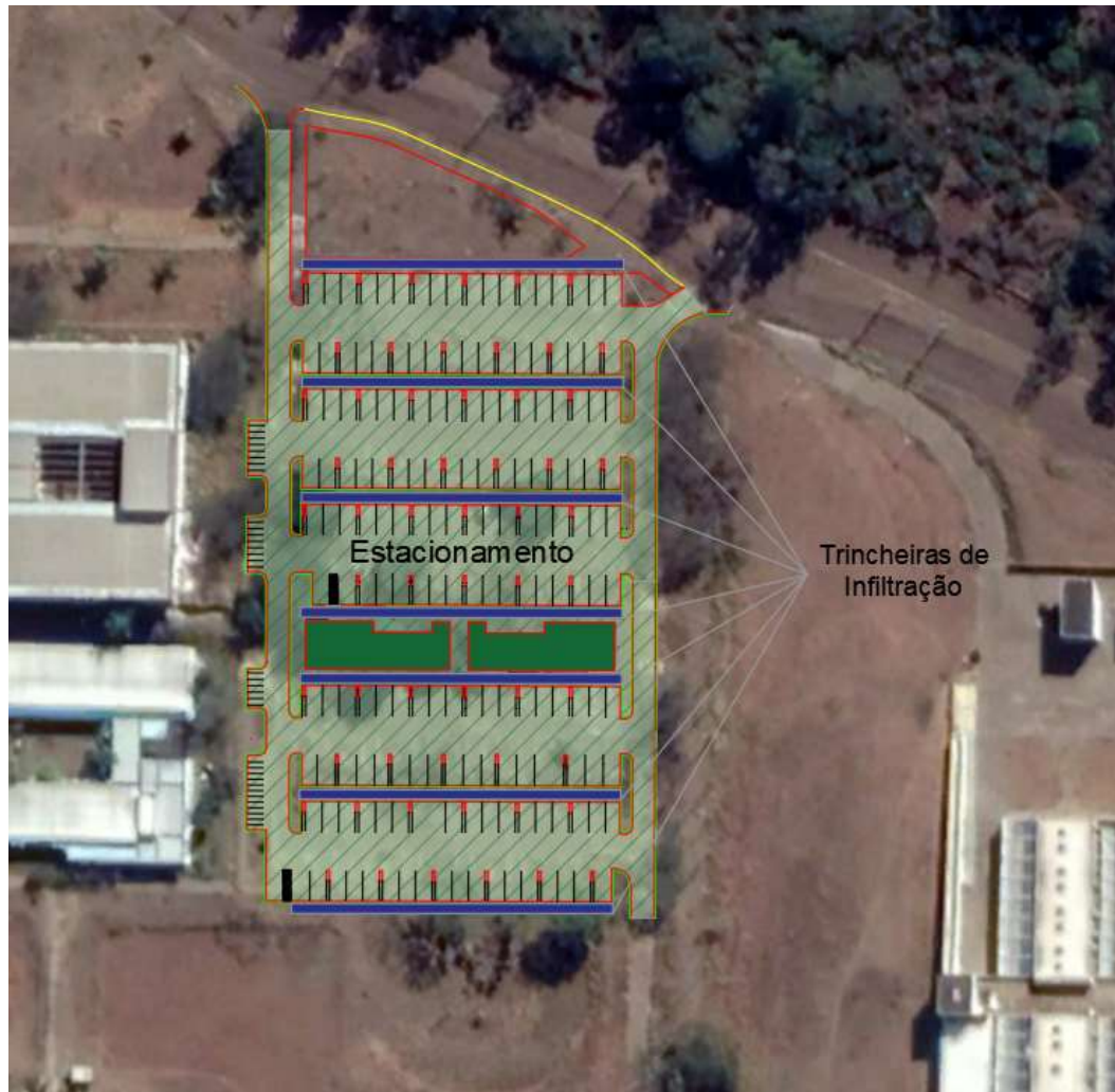
Figura 63 – Trincheiras de infiltração em estacionamento
