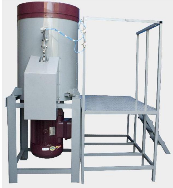
Figura 16 – Representação esquemática de um aglutinador
