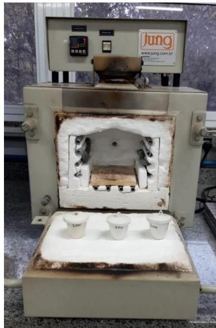
Figura 27 - Forno tipo mufla (LF00212, JUNG), usado na produção das cinzas
