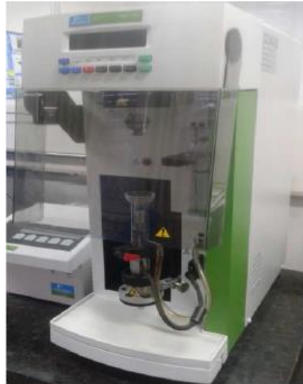
Figura 30 - TGA (Pyris1, Perkin Elmer) utilizado nas análises termogravimétricas
