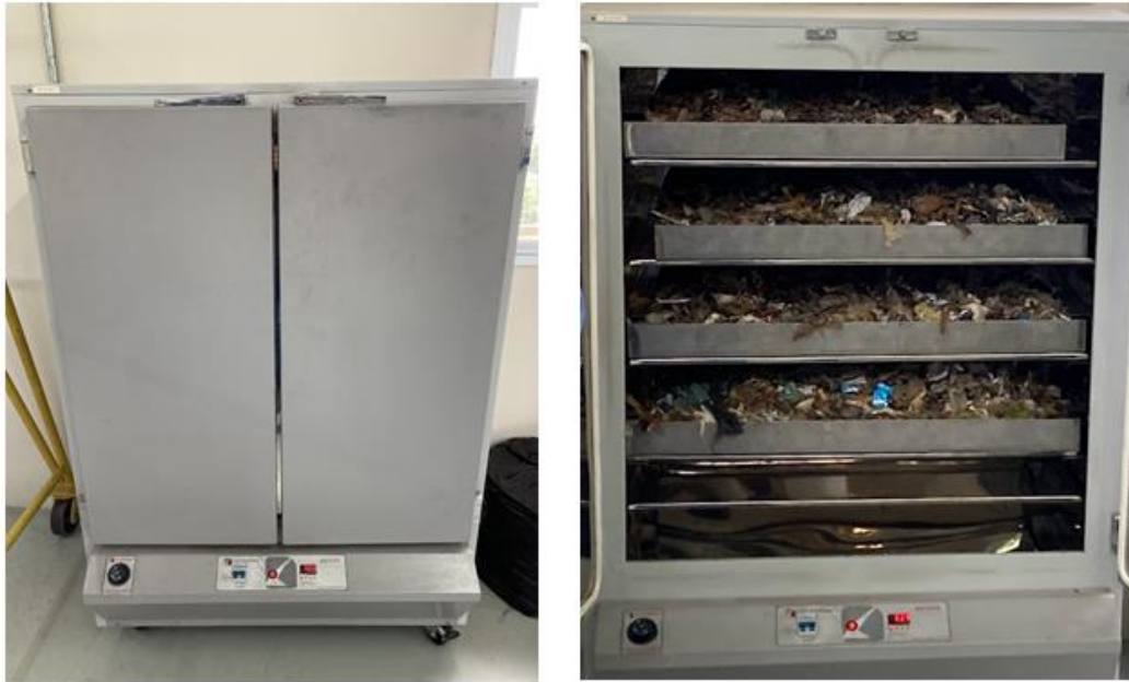
Figura 45 – Estufa com renovação e circulação de ar utilizado na pré-secagem dos materiais testados (Luca-82/40, Lucadema)
