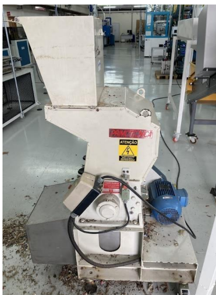
Figura 47 – Triturador utilizado na moagem dos materiais testados (P1004, Primotécnica)
