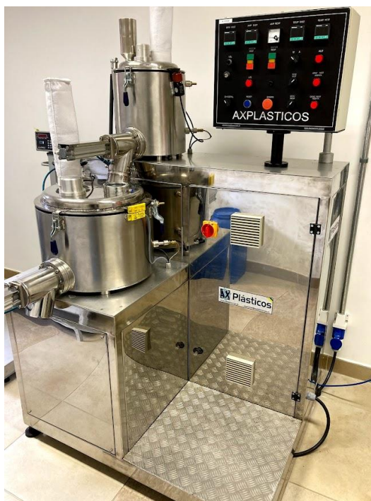
Figura 48 - Misturador utilizado nos testes para aglutinação do CDR (Mix.15.AX, AX Plásticos)
