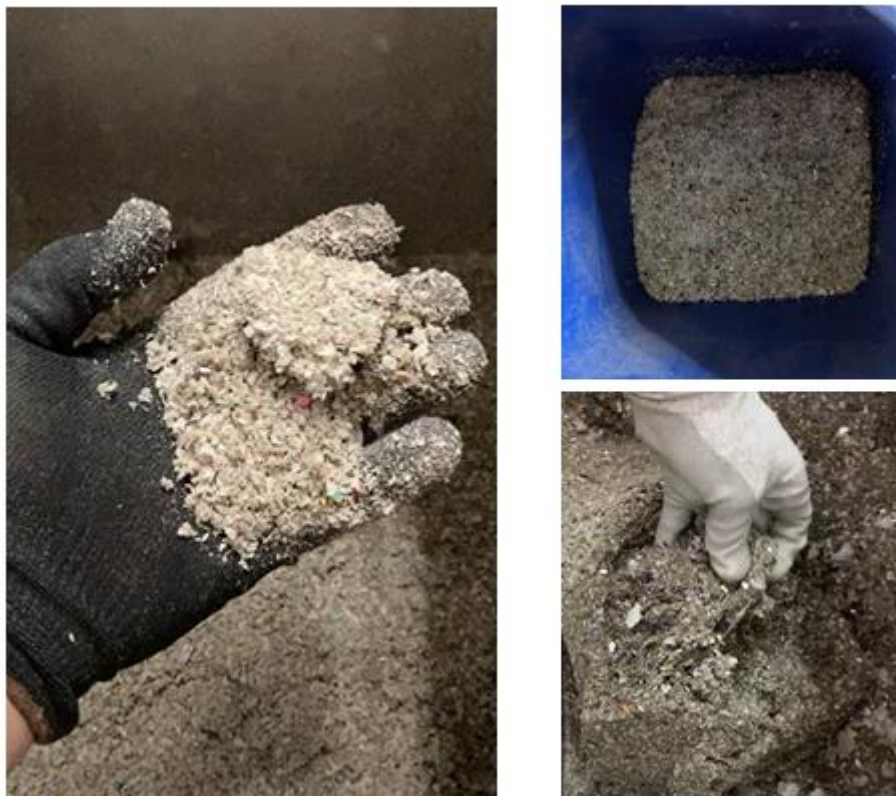
Figura 55 – Resultados do processo de aglutinação com a não formação de flakes realizados no aglutinador (AS500, Seibt), utilizado nos testes com CDR
