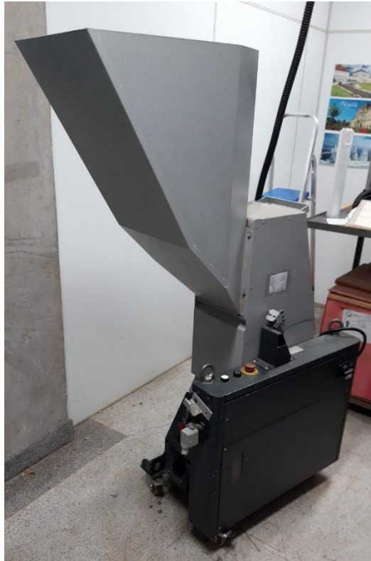
Figura 24 – Triturador utilizado na moagem dos materiais testados (TM-05, Lippel)
