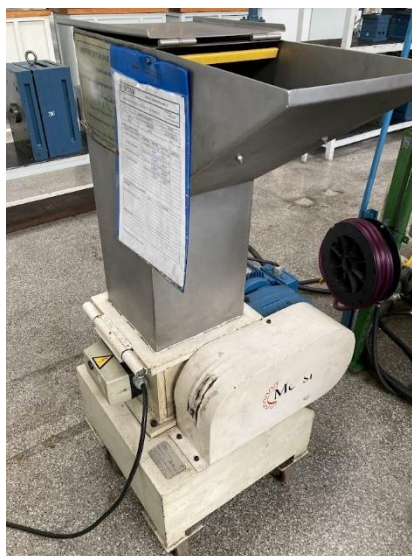
Figura 58 – Moinho de baixa velocidade (MP 20, Meysi, Brasil) utilizado na produção das misturas em formato de flakes 100% CDR e entre CDR e biomassas por meio de processo de extrusão
