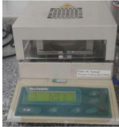
Figura 54 – Balança determinadora de umidade (ID 200, Marconi) utilizada na determinação da umidade das biomassas e misturas de CDR e biomassas em formatos de flakes
