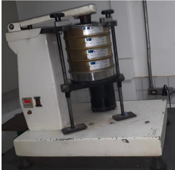
Figura 25 – Agitador orbital (MA 750, Marconi), com quatro peneiras (1/4 a 20 mesh , em ordem crescente) (Bertel)
