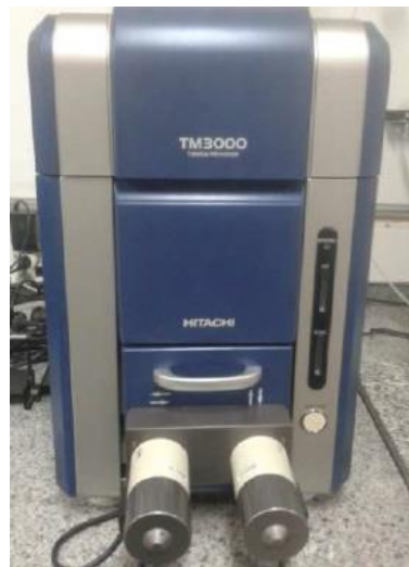
Figura 28 – Microscópio eletrônico de varredura (TM 3000, Hitachi) usado nas análises de MEV/EDS
