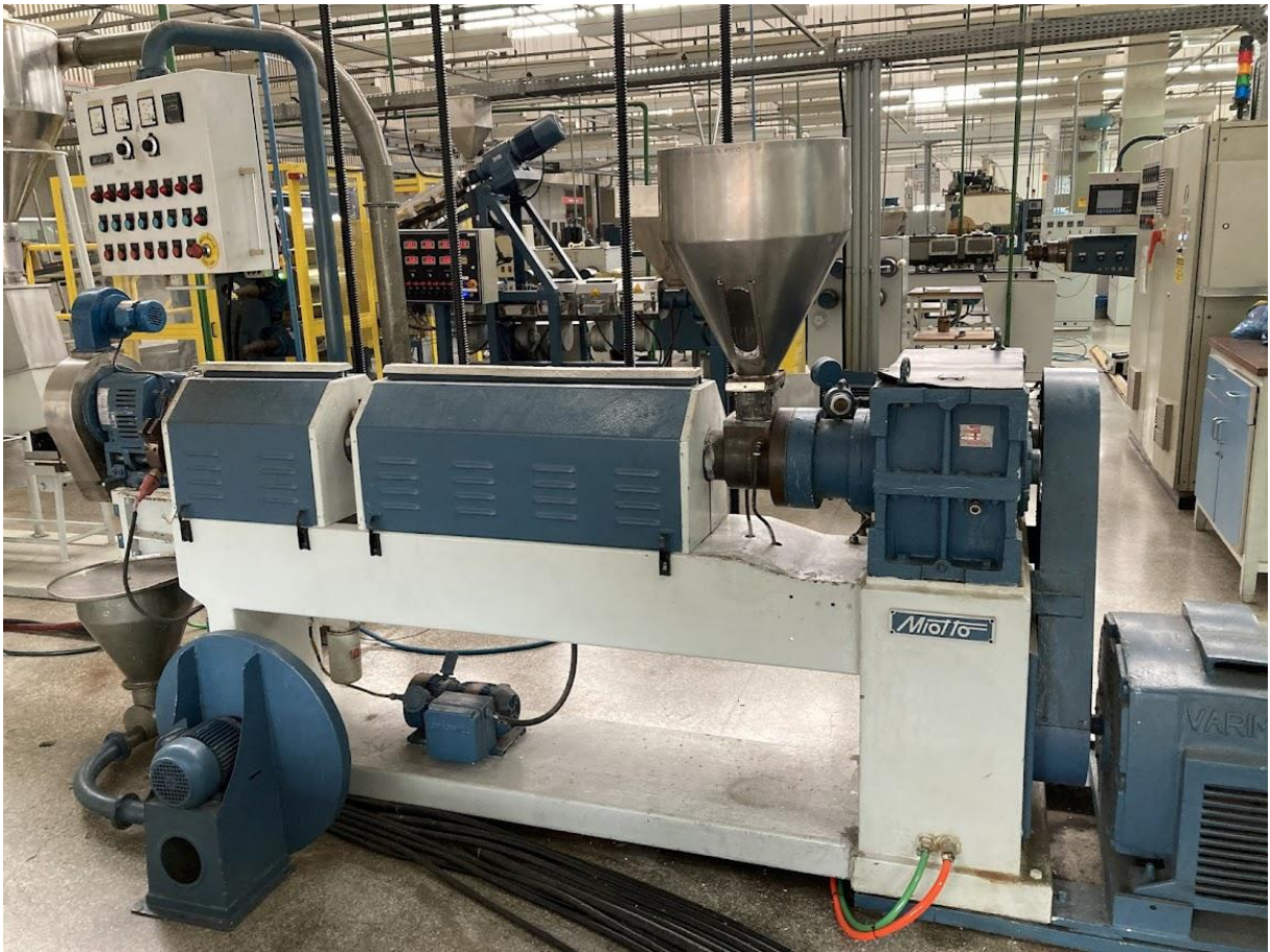
Figura 53 - Máquina de extrusão tipo monorosca parafuso com aquecedor na matriz (D.60X25D, Miotto) com capacidade de produção de 50 \text{ kg h}^{-1} , utilizado no processo de compactação dos materiais testados
