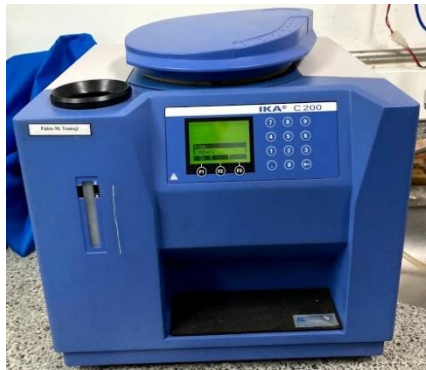
Figura 29 - Calorímetro usado na análise de poder calorífico superior (C200, IKA)
