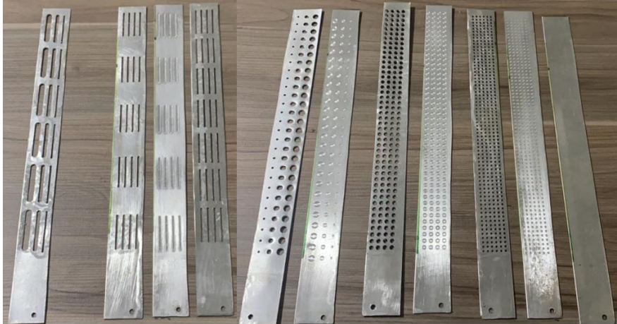
Figura 22 - Corpos de prova fabricados, após os processos de usinagem e corte de chapa
