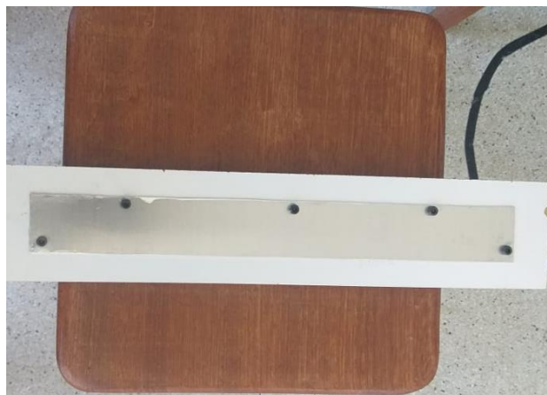
Figura 20 - Fixação da chapa na base para o processo de fresamento dos entalhes superficiais
