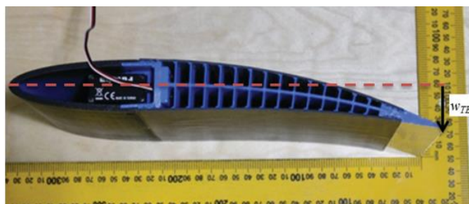
Figura 15 – Seção transversal de aerofólio com variação ativa de camber
