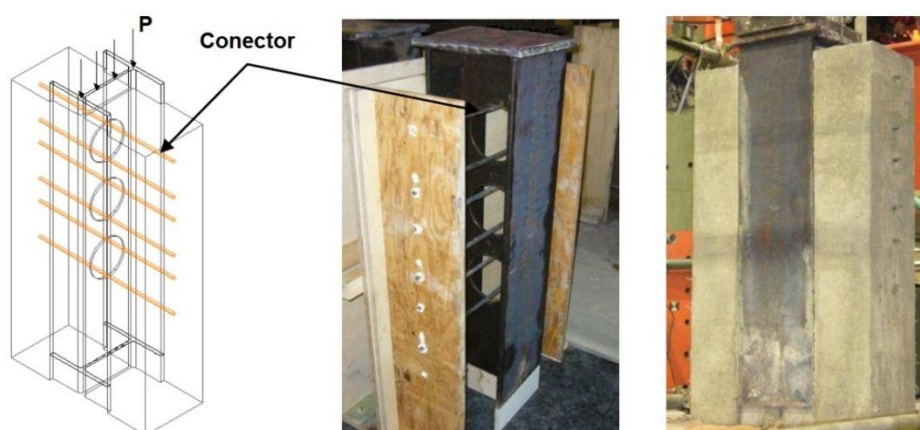
Figura 2.3: Ensaio de cisalhamento direto com barras transversais como conectores realizados por Huo (2012)
