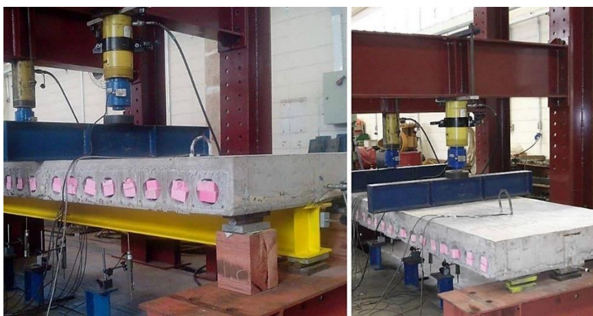
Figura 2.2: Esquema de ensaio a flexão em quatro pontos realizado por Souza (2016) – (a) Viga mista do piso convencional; (b) Viga mista do piso de pequena altura
