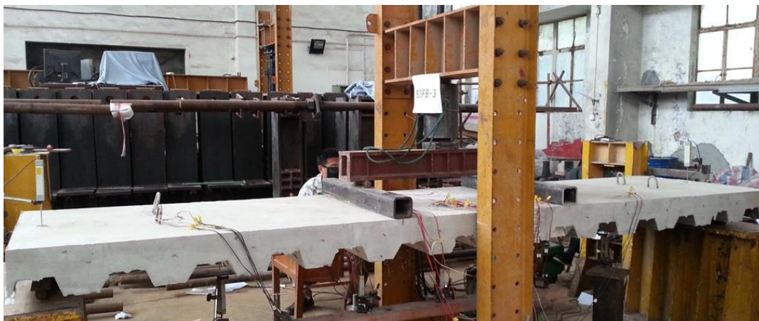
Figura 2.12: Montagem experimental do ensaio de flexão em quatro pontos
