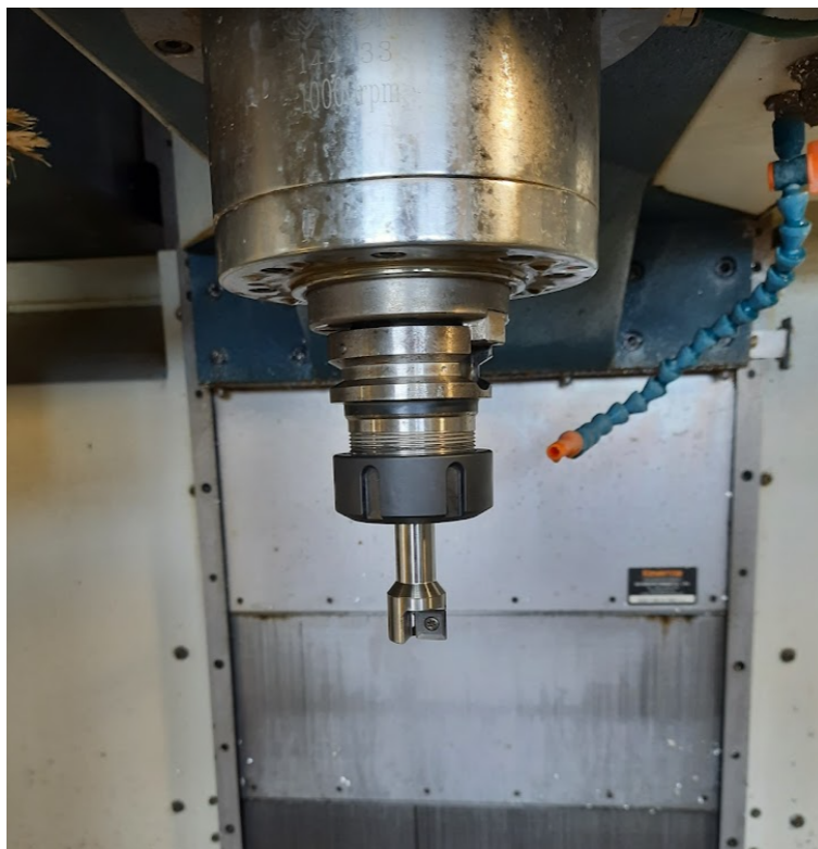
Figura 21 – Porta-ferramentas instalado no centro de usinagem ROMI D600.
