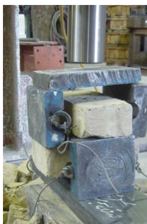
Figura 6 - Ensaio de tração, blocos cerâmicos cruzados.
