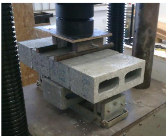
Figura 4 - Ensaio de flexão em prisma com quatro blocos.
