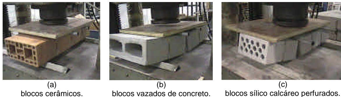
Figura 11 - Ensaio de flexão em quatro pontos do prisma.
