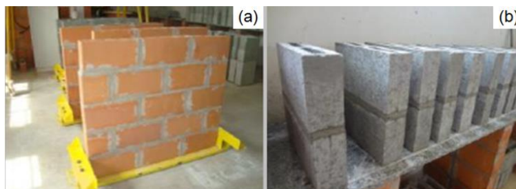
Figura 1 - Pequenas paredes com alvenaria estrutural cerâmica (a) e prismas com blocos de concreto (b).
