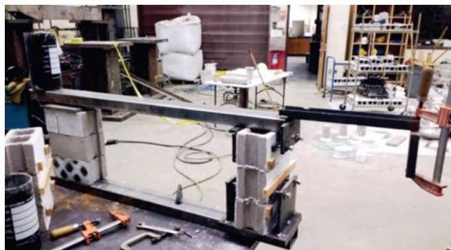
Figura 5 - Equipamento para ensaio de tração por alavanca.
