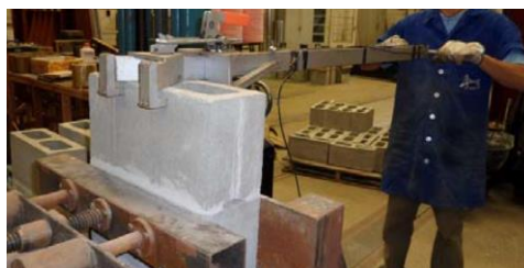
Figura 9 - Execução do ensaio de flexão com alavanca.
