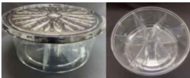
Figura 61. Recipiente teste para ensaio de fuga.
