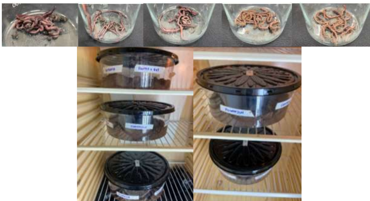
Figura 63. Minhocas selecionadas para o ensaio de fuga, recipientes-teste em incubadora BOD para manutenção de temperatura.
