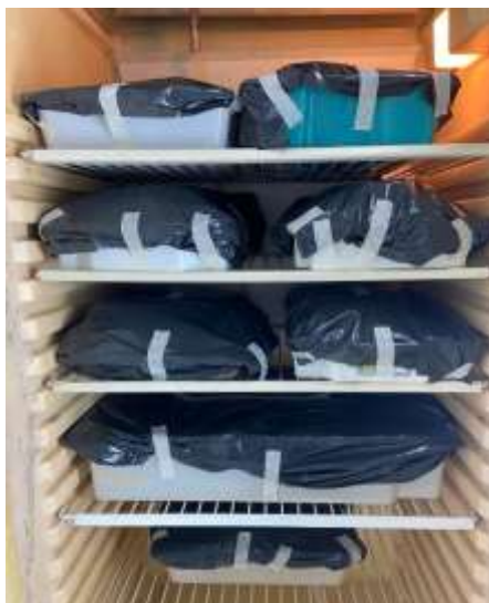
Figura 7. Bandejas vedadas com plástico preto em incubadora BOD.
