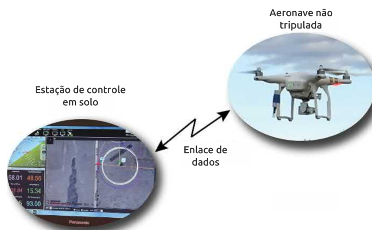
Figura 6 – Principais componentes de um Drone. Fonte: Frazier e Singh (2021).
