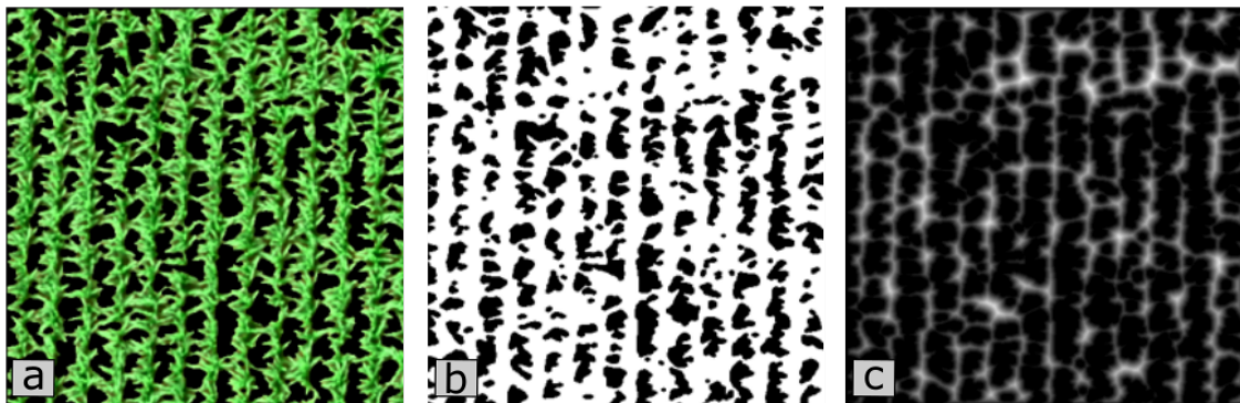
Figura 59 – Resultado da transformada de distância, utilizando (a) imagem segmentada, onde (b) máscara é operado por erosão, (c) mapa de distâncias com Euclidiana.
