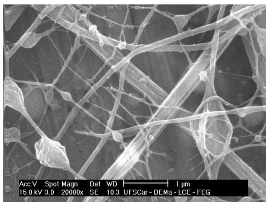
Figura 08 – Exemplo de MEV que apresenta defeitos de grânulo na morfologia das fibras
