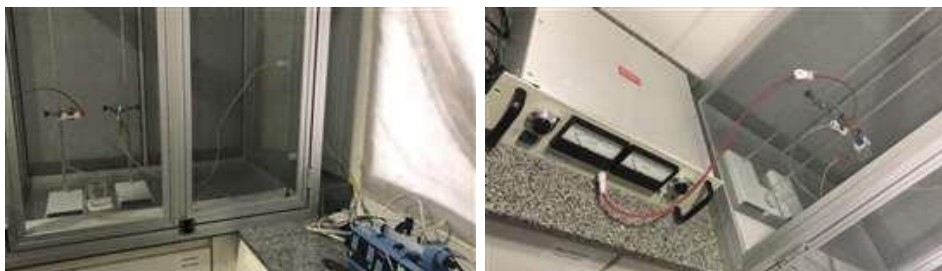
Figura 09 – Foto do aparato experimental utilizado nos experimentos de eletrofiliação
