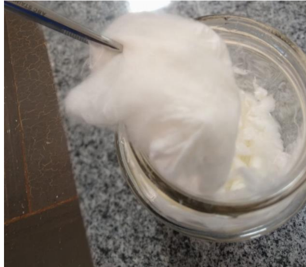
Figura 30. Amostra da fibra 60/40% HPMC-AS/Zeína coletada após a síntese.
