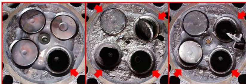
Figura 25 – Vista da área inferior do cabeçote referente ao 4°, 5° e 6° cilindro respectivamente
