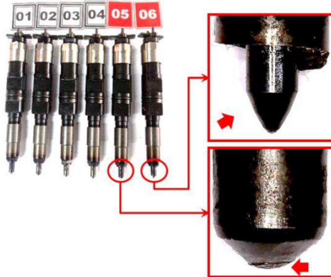
Figura 27 – Injetores de combustível (detalhe de amassamento da ponta do 5° injetor e fratura da ponta do 6° injetor de combustível)
