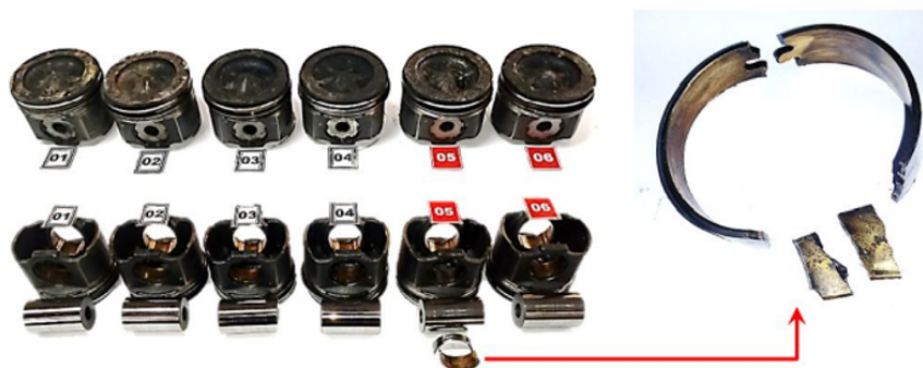
Figura 34 – Conjunto de pistões (detalhe para a fratura na bucha do pino do pistão do 5° cilindro)
