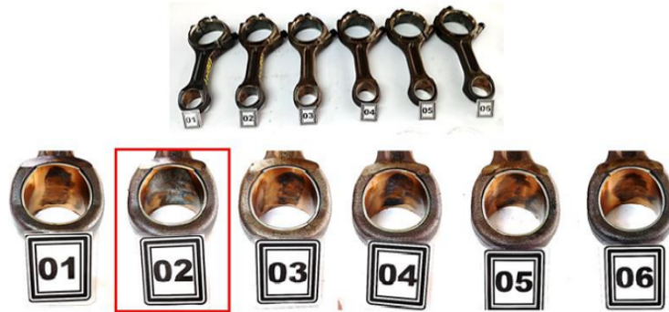
Figura 37 – Conjunto de bielas (detalhe para o desgaste acentuado na bucha do olhal da biela do 2° cilindro)
