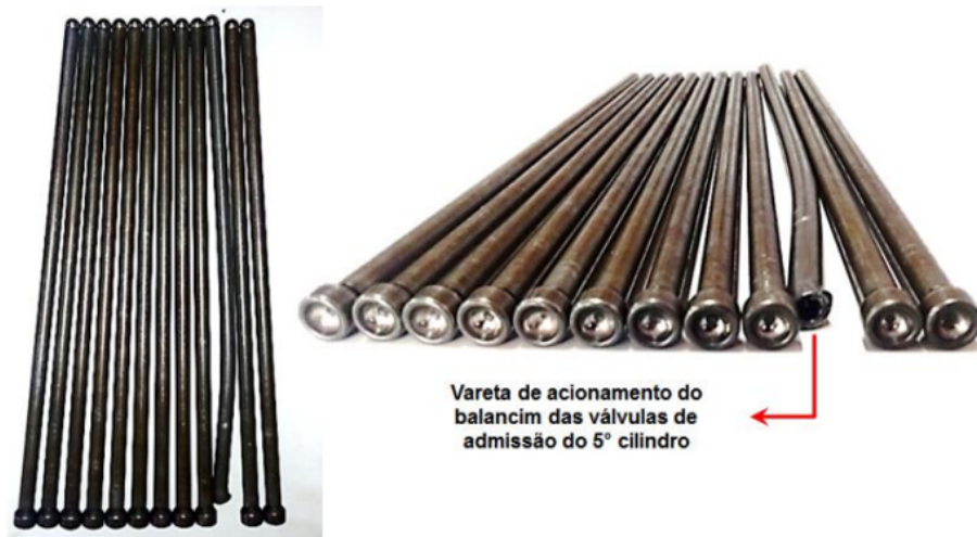
Figura 31 – Conjunto de varetas (detalhe da fratura na ponta e empeno da vareta de acionamento do balancim de escape do 5º cilindro)
