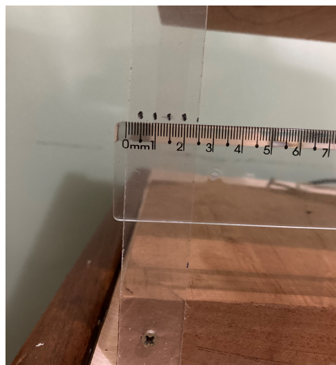
Figura 9 – Marcações na Viga para Aplicação de Danos.
