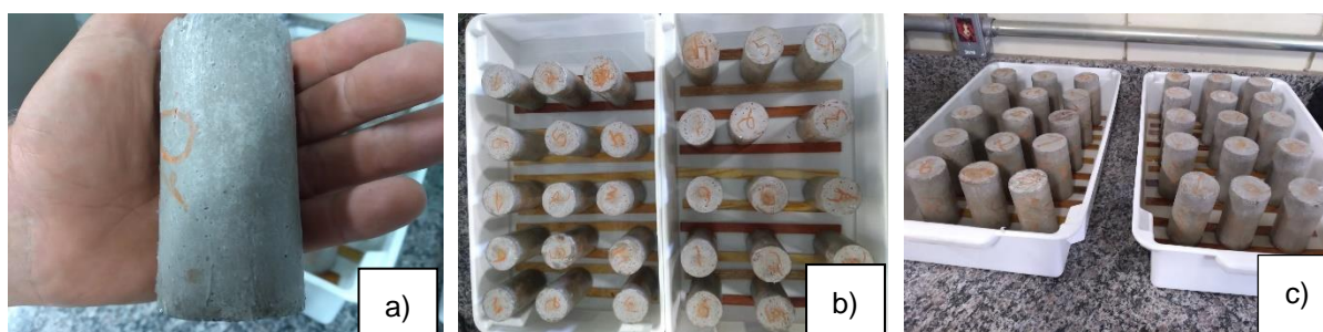
Figura 3.14 - a) Corpos de prova utilizados no ensaio de absorção de água por capilaridade: impermeabilização da amostra com silicone; b) corpos de prova dispostos sobre as lâminas de madeira e c) amostras em contato com a lâmina d'água.
