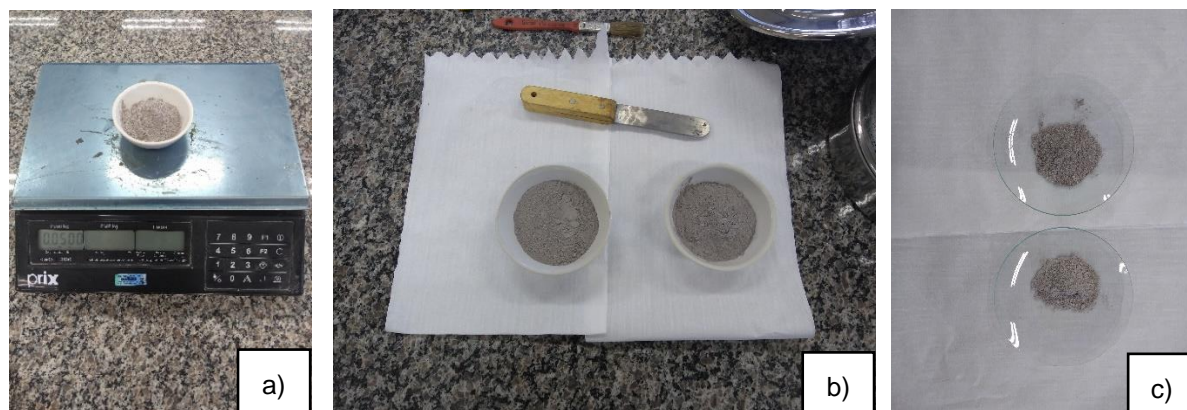
Figura 3.5 – a) e b) Amostra de Ecat para ensaio de índice de finura; c) material retido na peneira nº200
