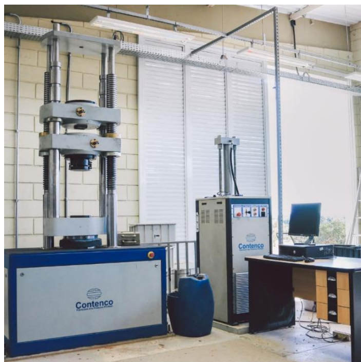
Figura 3.11 - Prensa utilizada para o ensaio de resistência à compressão
