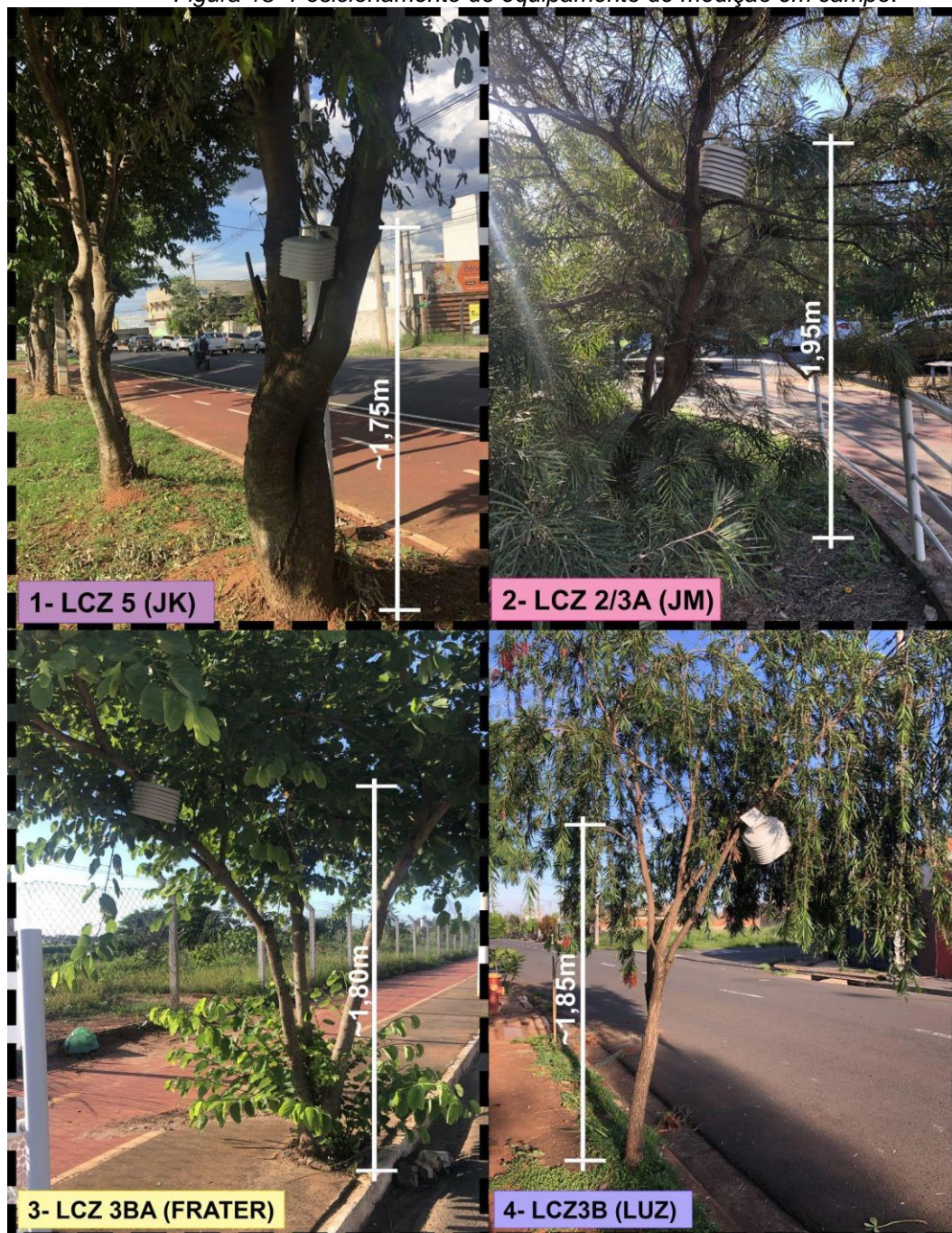
Figura 18- Posicionamento do equipamento de medição em campo.
