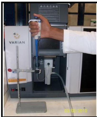
**Figura 2.3.** Ilustração do sistema de aspiração discreta.
