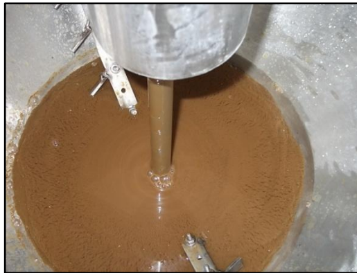
Figura 9.1.4: a) Decantador utilizado para separação sólido/líquido (última etapa do tratamento). b) Detalhe interno do decantador com raspador, contendo a polpa de gesso espessada ao fundo.
