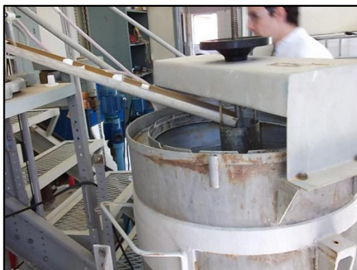
Figura 9.1.4: a) Decantador utilizado para separação sólido/líquido (última etapa do tratamento). b) Detalhe interno do decantador com raspador, contendo a polpa de gesso espessada ao fundo.
