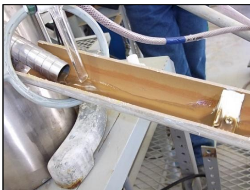
Figura 9.1.3: a) Primeiro reator de tratamento de efluente da BNF utilizando polpa de gesso: introdução de efluente bruto e de polpa de gesso. b) Detalhe da saída de efluente do último reator (reator de saída) junto à calha de ligação ao decantador.
