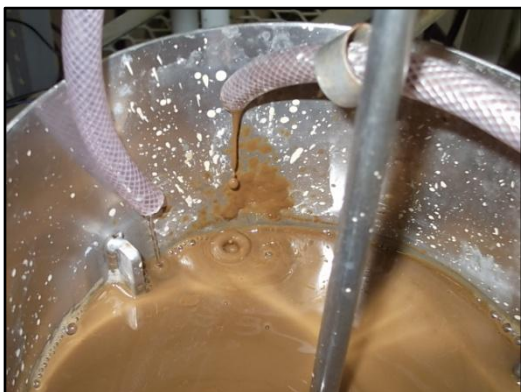
Figura 9.1.3: a) Primeiro reator de tratamento de efluente da BNF utilizando polpa de gesso: introdução de efluente bruto e de polpa de gesso. b) Detalhe da saída de efluente do último reator (reator de saída) junto à calha de ligação ao decantador.
