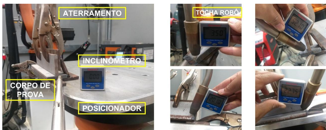
Figura 21: Arranjo experimental de testes soldagem realizados pelo fabricante da máquina de solda.
