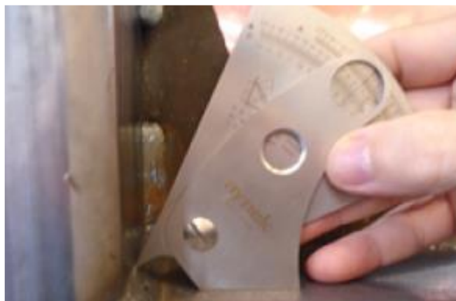
Figura 23: Dimensionamento do cordão de solda.
