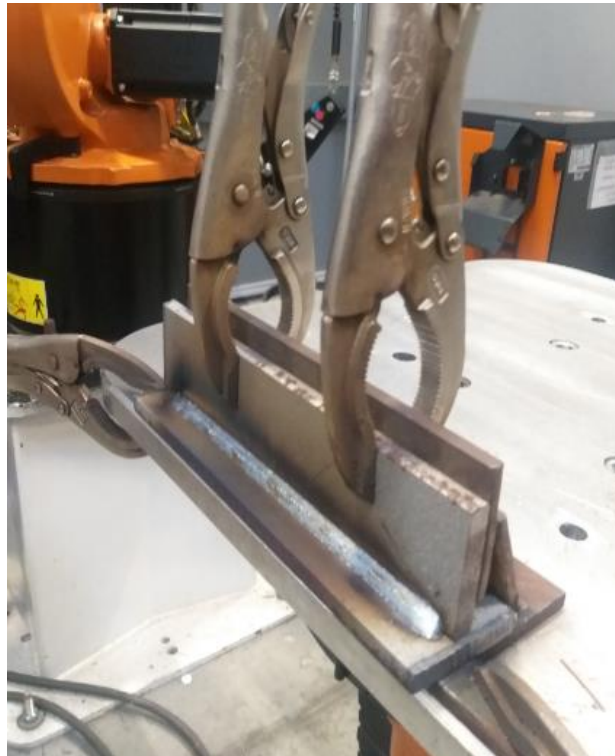
Figura 34: Aspecto visual do cordão de solda associado ao teste inicial para cordão a5 e posição 2F.
