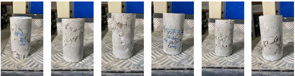
Figura 4.10 – Modo de ruptura do PV50-F2 aos 56 dias.
