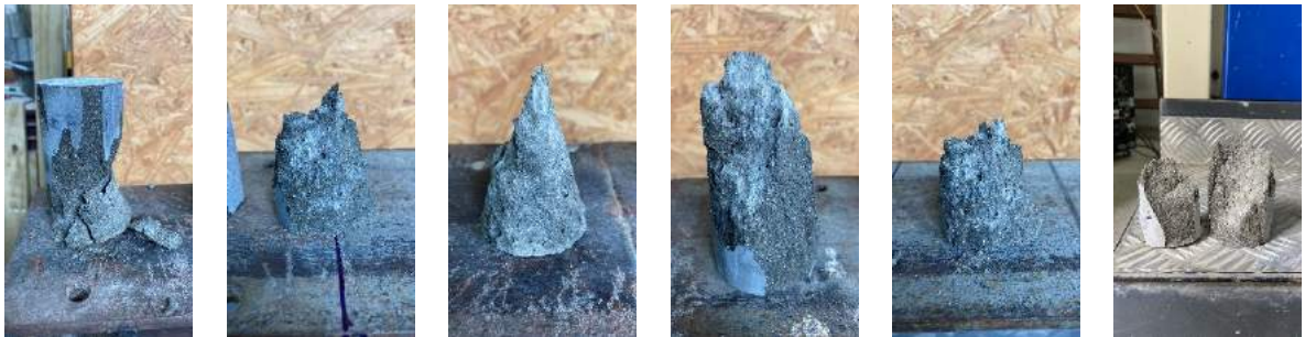
Figura 4.9 – Modo de ruptura do REF aos 56 dias.
