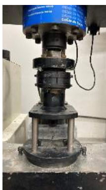
Figura 3.15 – Aparato e corpo de prova durante ensaio de determinação de resistência à tração na flexão.
