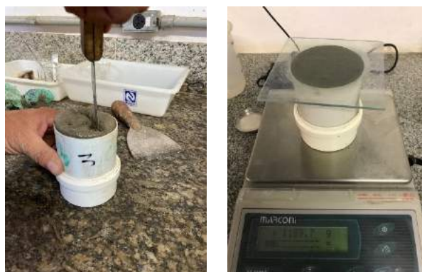
Figura 3.12 – Ensaio de densidade de massa e de teor de ar incorporado.
