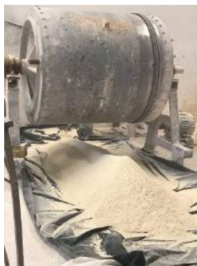
Figura 3.4 – Moinho utilizado e o pó de vidro após a segunda moagem.
