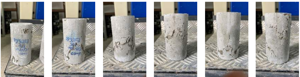
Figura 4.11 – Modo de ruptura do PV50-F3 aos 56 dias.
