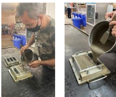
Figura 3.10 – Moldagem dos espécimes prismáticos (40x40x160 mm).
