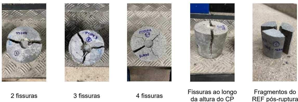
Figura 4.12 – Padrão de fissuração nos corpos de prova do ensaio de duplo puncionamento.
