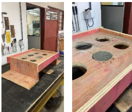
Figura 3.9 – Moldagem dos exemplares cilíndricos (100x200 mm).
