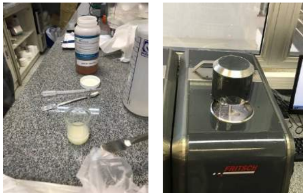
Figuras A.1 – a) Preparação da amostra para o ensaio de granulometria (esquerda); b) aparelhagem para a realização do ensaio de granulometria (direita).
