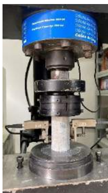
Figura 3.14 – Aparato e corpo de prova durante ensaio de determinação de módulo de elasticidade.
