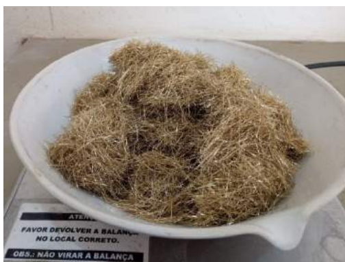
Figura 4.1 – Fibras metálicas – Dramix® OL 13/20 .
