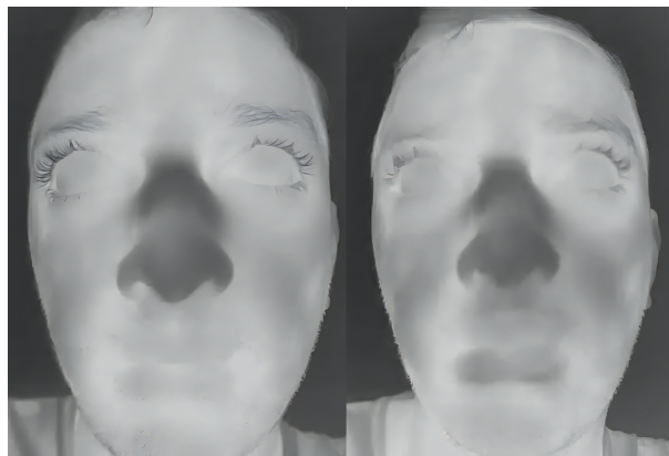
Figura 25 – Comparação entre um quadro capturado após o dispositivo térmico ser inicializado e 20 minutos após o dispositivo aquecer.
