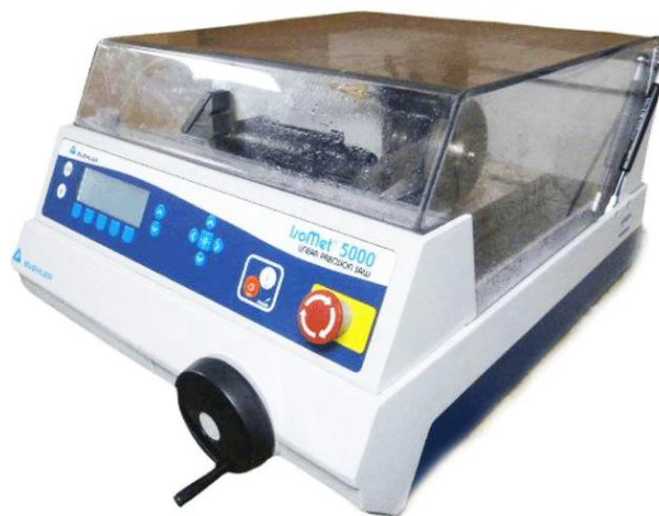
Figura 11: máquina de corte ISOMET 5000 utilizada para cortar a liga CrCoNi.
