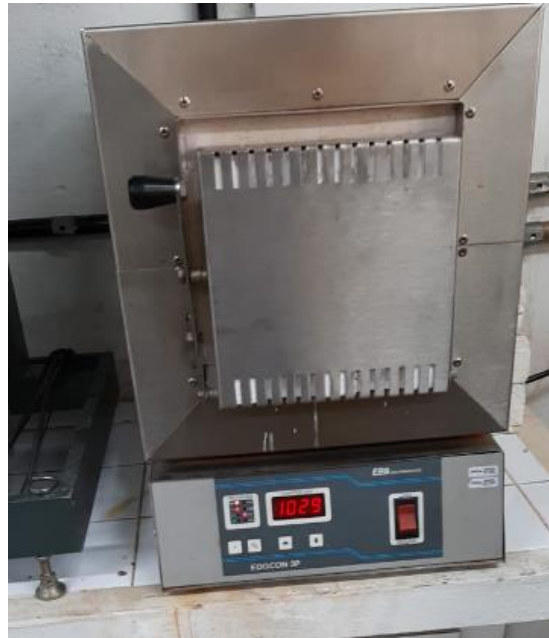
Figura 13: Forno utilizado para realização de processo de homogeneização das amostras II e III.
