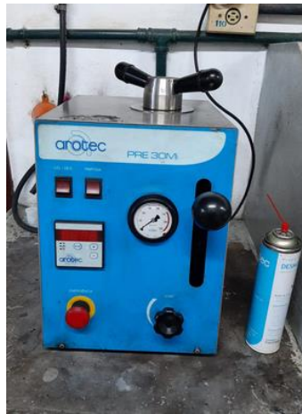
Figura 15: Máquina AROTEC pre 30Mi usada nos embutimentos realizados. As amostras depois de já embutidas a quente, em baquelite, passaram por procedimento de lixamento e polimento. A sequência de lixas utilizadas foi G 240, G320, G400, G600, G1200, G1500, G200 e G2500.
