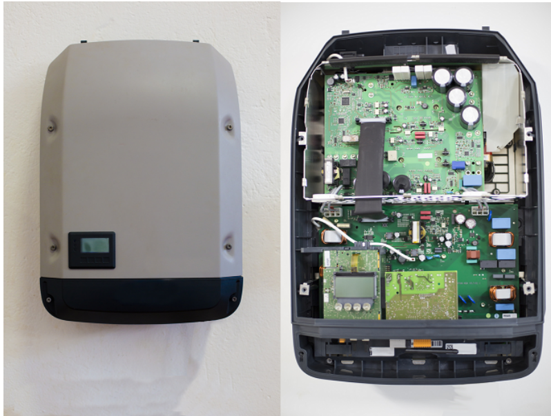
Figura 18 – Exterior e interior de um inversor comercial
