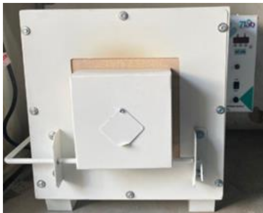
Figura 8. Equipamento mufla utilizada para análise de teor de carga
