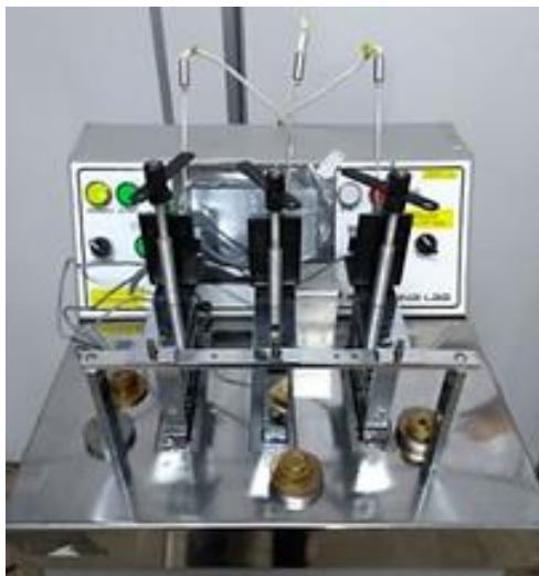
Figura 6. Equipamento utilizado para análise de HDT
