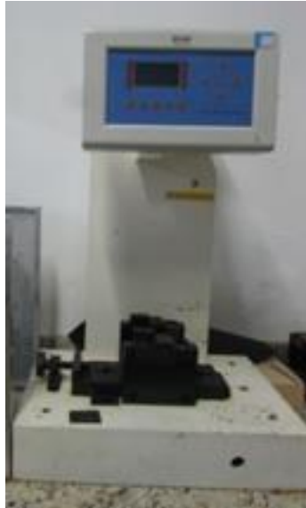
Figura 10. Equipamento utilizado para ensaio de impacto Charpy
