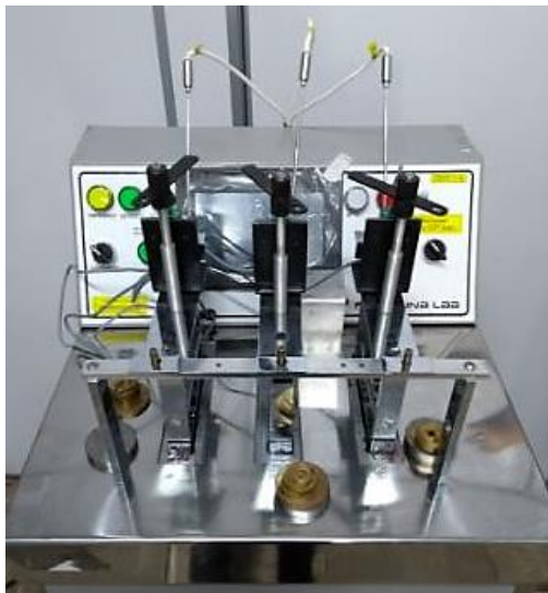
Figura 9. Equipamento utilizado para o ensaio de temperatura de amolecimento Vicat
