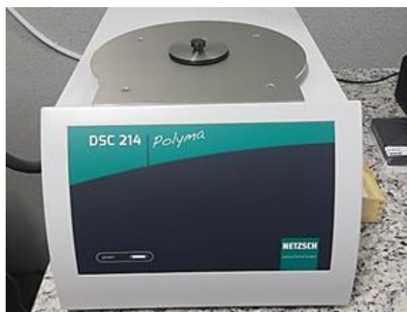
Figura 3. Equipamento utilizado para análise de DSC
