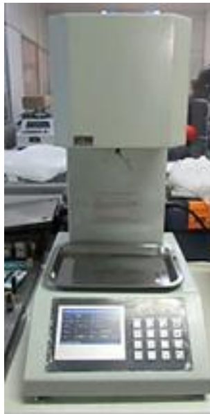
Figura 7. Equipamento plastômetro utilizado no ensaio de índice de fluidez
