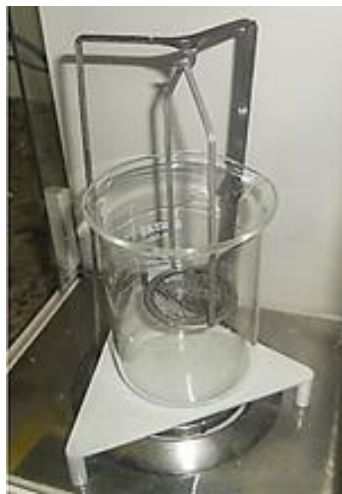
Figura 5. Kit utilizado para análise de densidade
