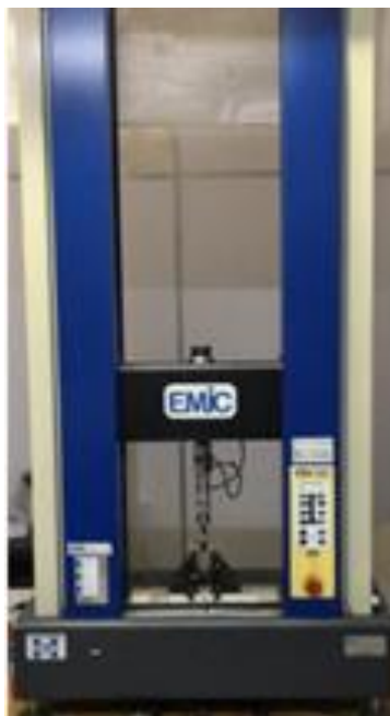
Figura 11. Equipamento utilizado para ensaio de flexão
