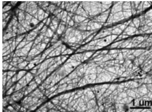
Figura 3: Microscopia eletrônica de transmissão da suspensão diluída das CNFs de Opuntia ficus-indica .
