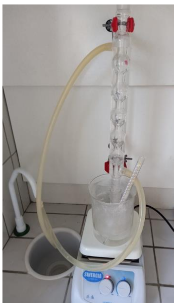
Figura 12: Condensador de refluxo utilizado nas reações.
