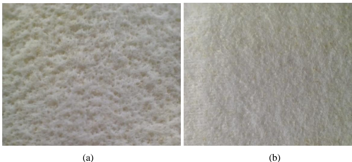
Figura 27 – Amostras dos meios filtrantes meta-aramida (a) agulhado e (b) hidrojateado.
