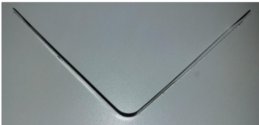
Figura 53 – Chapa dobrada com ângulo de 87^\circ e raio de 6,0 mm como proposta de compensação do retorno elástico.
