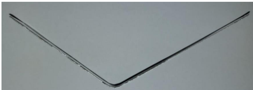
Figura 42 – Chapa de 0,4 mm dobrada com ferramenta de raio 5,5 mm.
