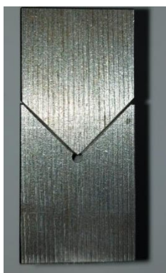
Figura 24 – Montagem entre a matriz e o punção com raio de 1,0mm.
