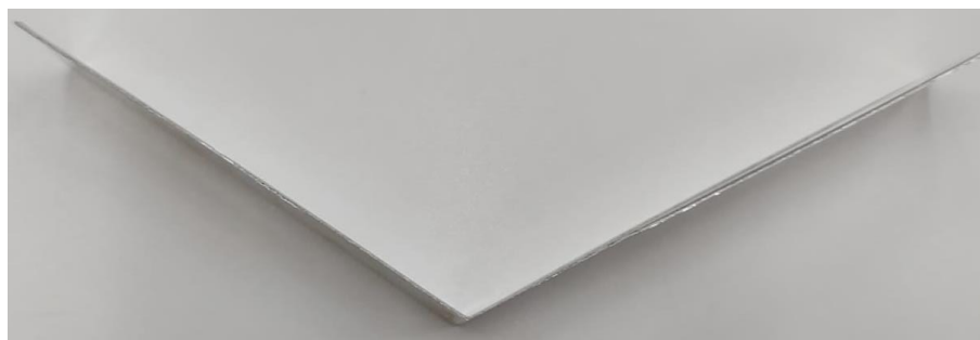
Figura 52 – Chapa dobrada com ângulo de 122° e raio de 0,4 mm como proposta de compensação do retorno elástico.
