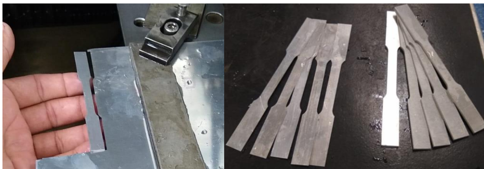
Figura 19 – Confeção dos corpos de prova para o ensaio de tração
