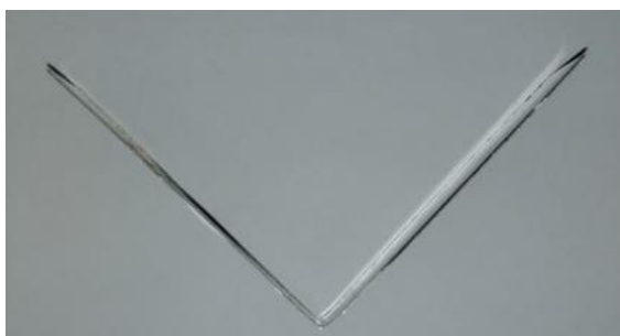
Figura 41 – Chapa de 0,4mm dobrada com ferramenta de raio 1,0 mm.
