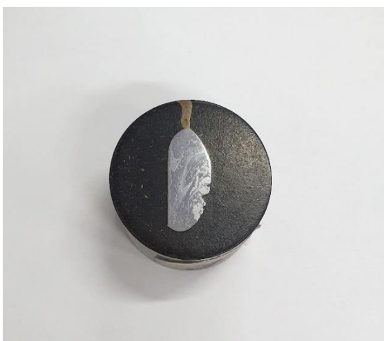
Figura 3.1- Amostra de lingote da liga eutética ultrafina produzida em forno a arco, na composição de Fe 81 Nb 9 B 10 (% at.).
