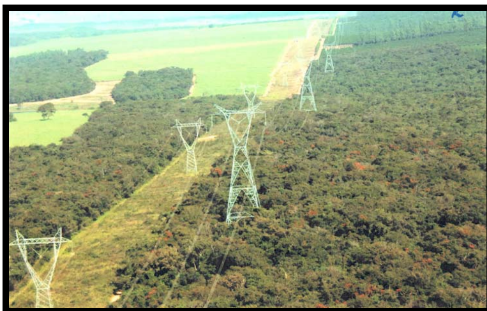
Figura 26. Fotografia aérea da localização das torres de transmissão autoportantes 204/1 a 205/2, localizadas na Fazenda Pântano, todas inseridas em meio a vegetação de Cerrado (cerradão). Martins Filho, C. A. de S. (2008).
