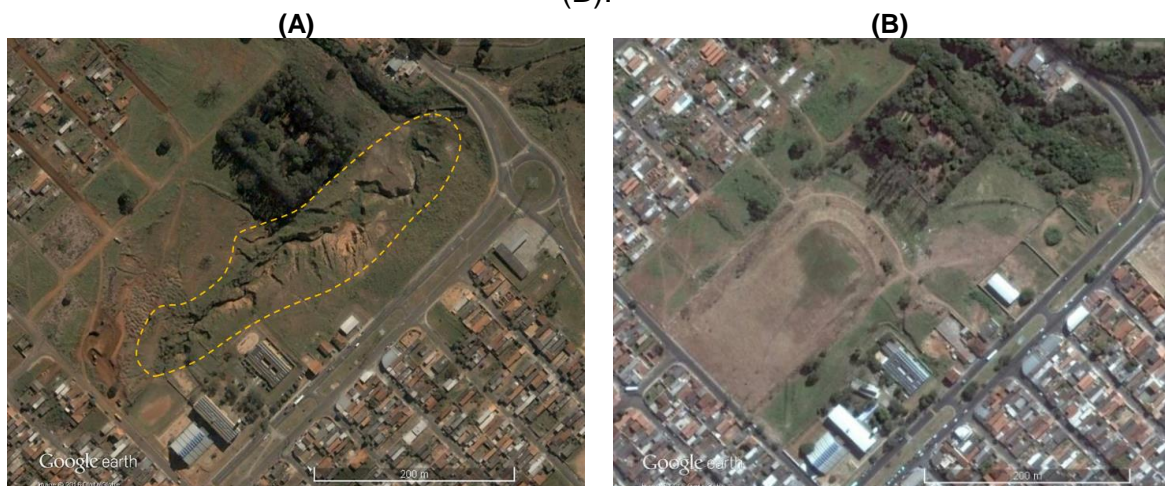
Figura 54 - Voçoroca existente na área em 2004 (A) e após o aterramento em 2016 (B).
