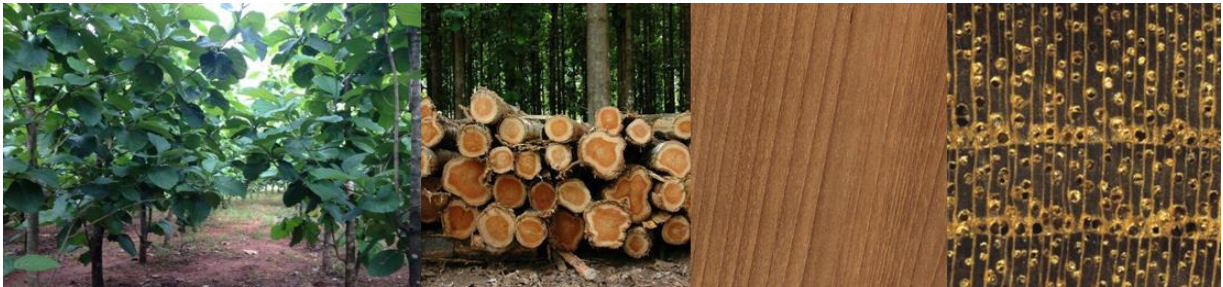
Figura 18- Plantio de Teca, detalhe para a sua morfologia (a). Colheita de Teca, cerne e alborno bem separados visualmente (b). Fotomacrografia de imagem transversal (c) e de 10x (d).
