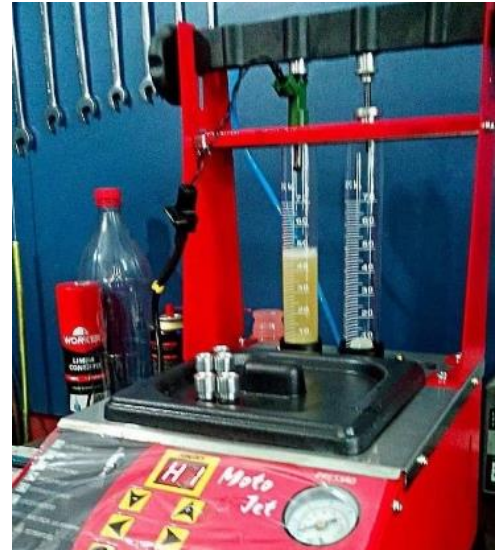
Figura 8: Medição da vazão do bico injetor
