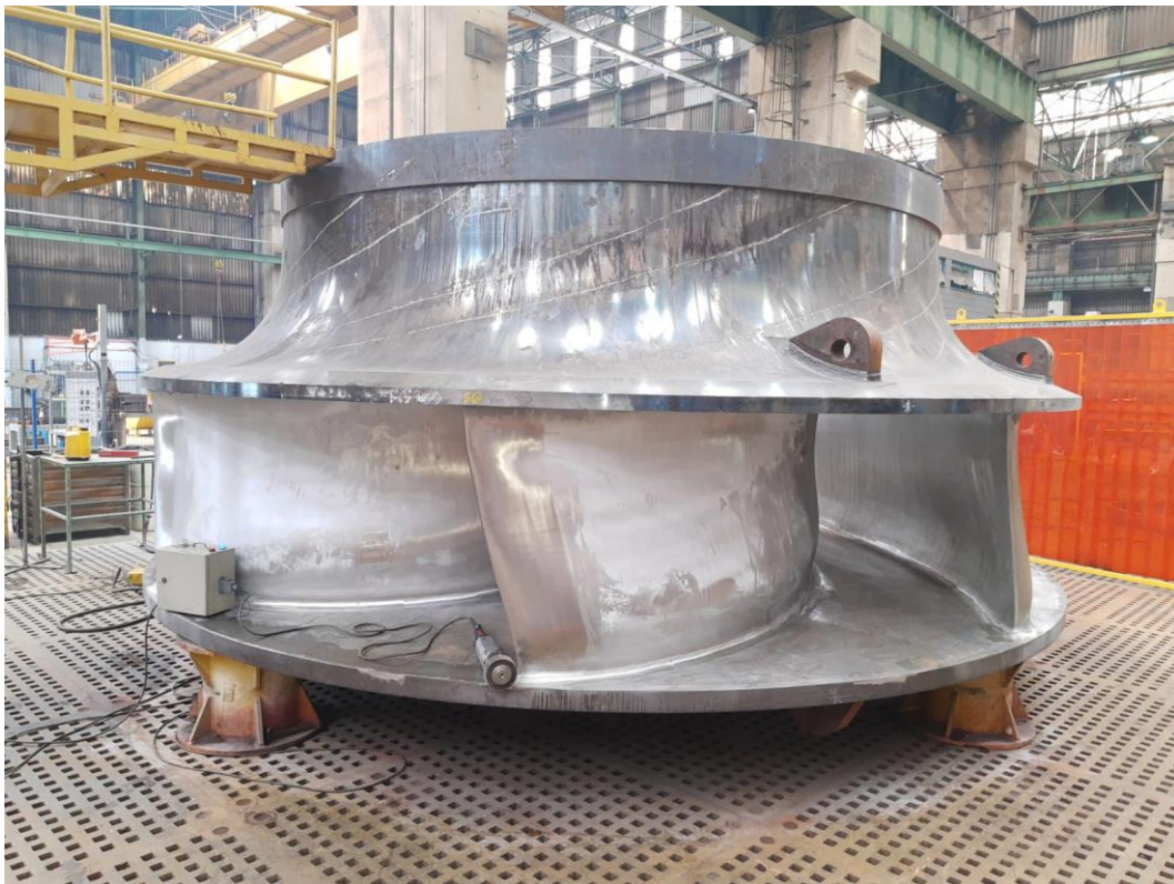
Figura 13 – Rotor Francis após etapa de soldagem.
