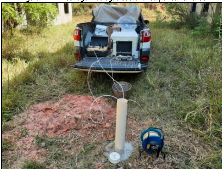
Figura 14 - Amostragem de água subterrânea por baixa vazão
