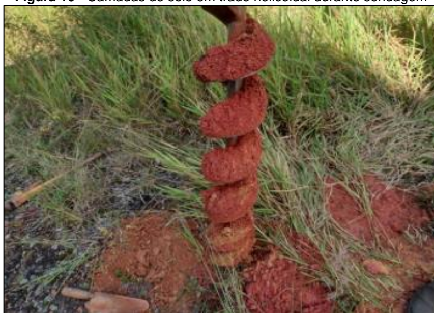
Figura 10 - Camadas de solo em trado helicoidal durante sondagem
