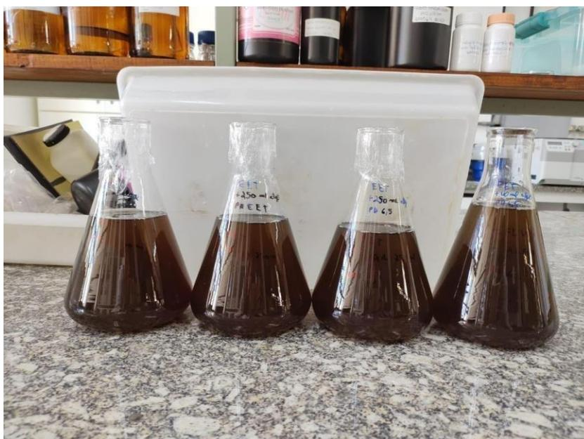
Repetiu-se novamente a retirada das alíquotas de 50 mL para a realização das análises de pH, turbidez e condutividade elétrica (CE) (Figura 8). O procedimento do experimento durou cerca de 17 dias.
