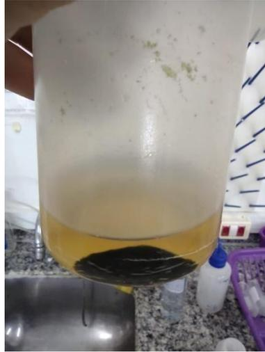
Após o processo da centrifuga, as amostras foram levadas até uma estufa com temperatura de 60°C por 3 dias, para não danificar as proteínas e vitaminas das amostras. A Figura 11 ilustra as amostras após o processo de secagem, sendo que a direita da imagem representa a biomassa algal das amostras 100 mL, pH 6,5 (acima) e 100 mL, pH (EET) (abaixo) e à esquerda, contém a biomassa das amostras 250 mL, pH 6,5 (acima) e 250 mL, pH EET (abaixo).
