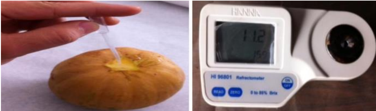
Figura 3 – Avaliação de Sólidos Solúveis dos frutos maduros, utilizando refractometry digital modelo HI 96801 – Hanna
